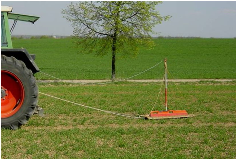
Abbildung 15: Messung der scheinbaren elektrischen Leitfähigkeit
