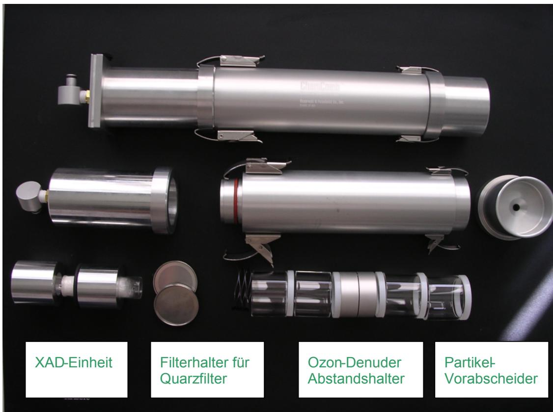
Abbildung 6: Einzelkomponenten der Probenahmekartuschen
