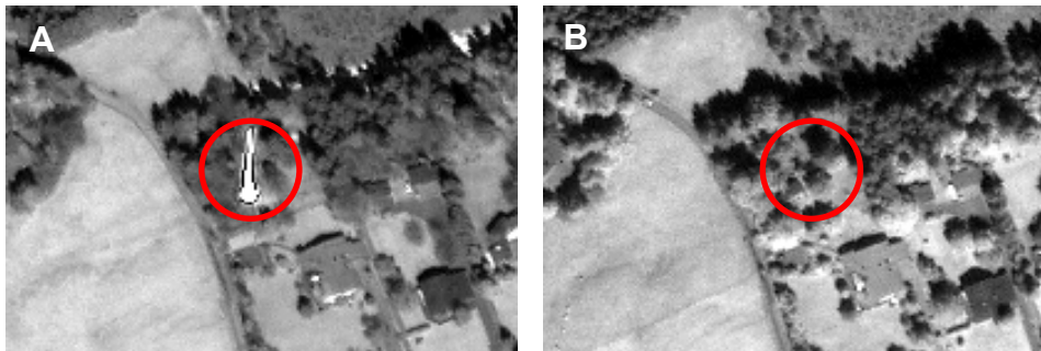
Abb. 16: Übersteuerungspunkt (roter Kreis) in der IKONOS-PAN-Aufnahme vom April (A). Die August-Aufnahme (B) ist radiometrisch korrekt und weist keine Übersteuerungspunkte auf.
