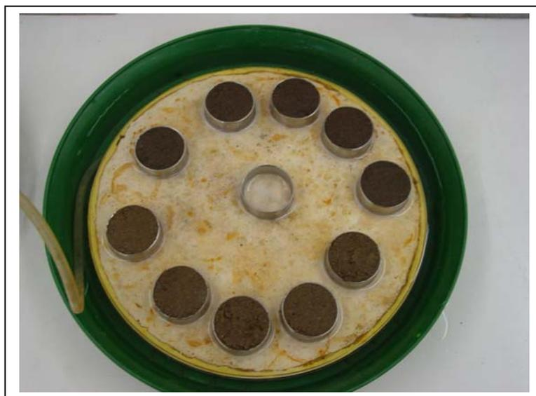
**Abb. 12: Bodengefüllte Stechzylinder auf einer Tonplatte**
