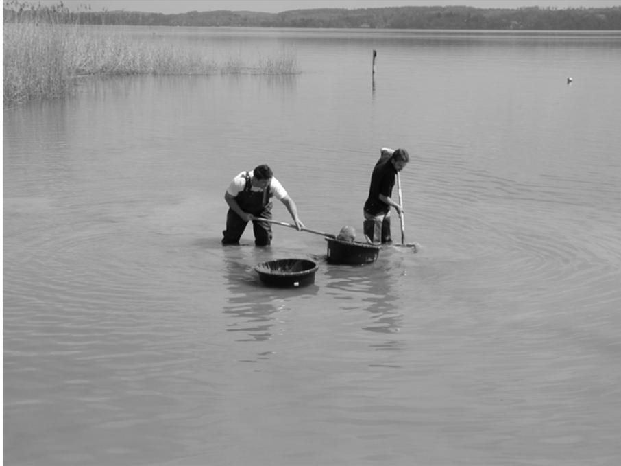
**Abbildung 9:** Sedimententnahme an einer oligo-mesotrophen Litoralstelle des Ammersees bei Schondorf für den Mikrokosmenversuch 2000.
