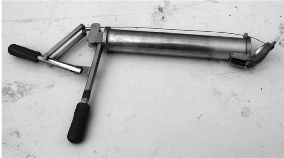
**Abbildung 12:** Probenehmer aus Edelstahl zur Entnahme von Zooplankton aus den Mikrokosmen; Fassungsvermögen: 0,5 L.
