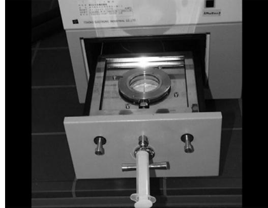
Abbildung 53: Links: Einwaage von Malzschrot in das Probenschälchen; Rechts: Probenschälchen im Probenraum (offen) mit der Spritze zur Wasserzugabe. Neben der Spritze sind die Gasanschlüsse sichtbar, durch die der Probenraum gespült werden konnte.
