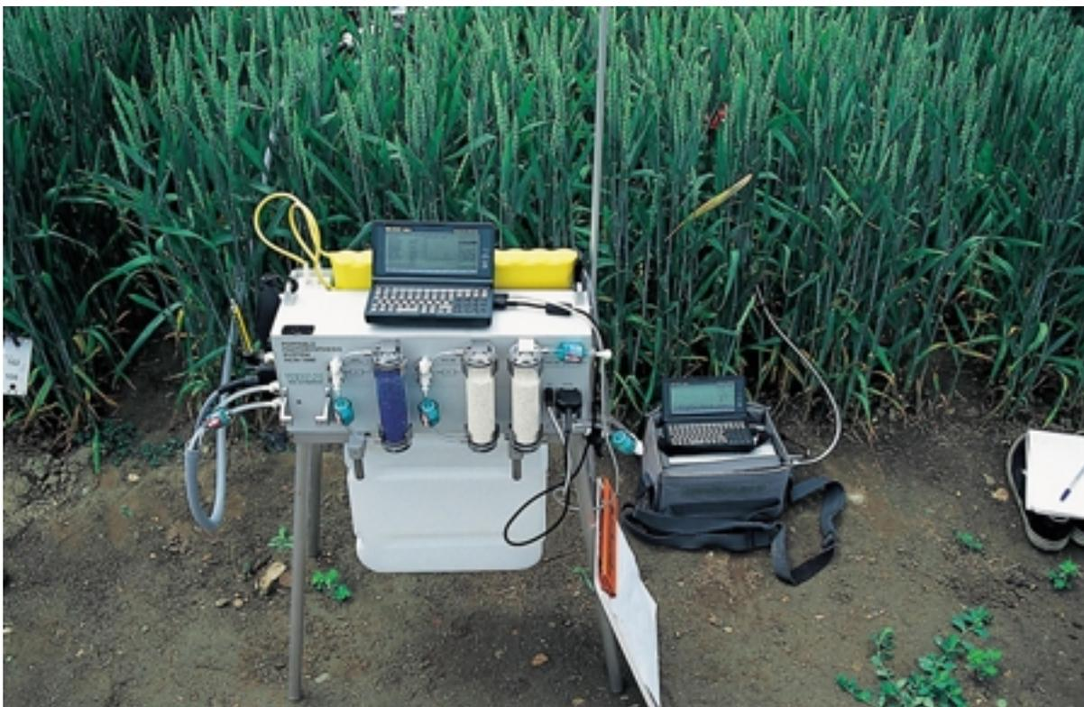
**Abb: 34:** Das portable Gaswechsel-Meßgerät HCM-1000 (Fa. Walz, Effeltrich) im Feldeinsatz.
