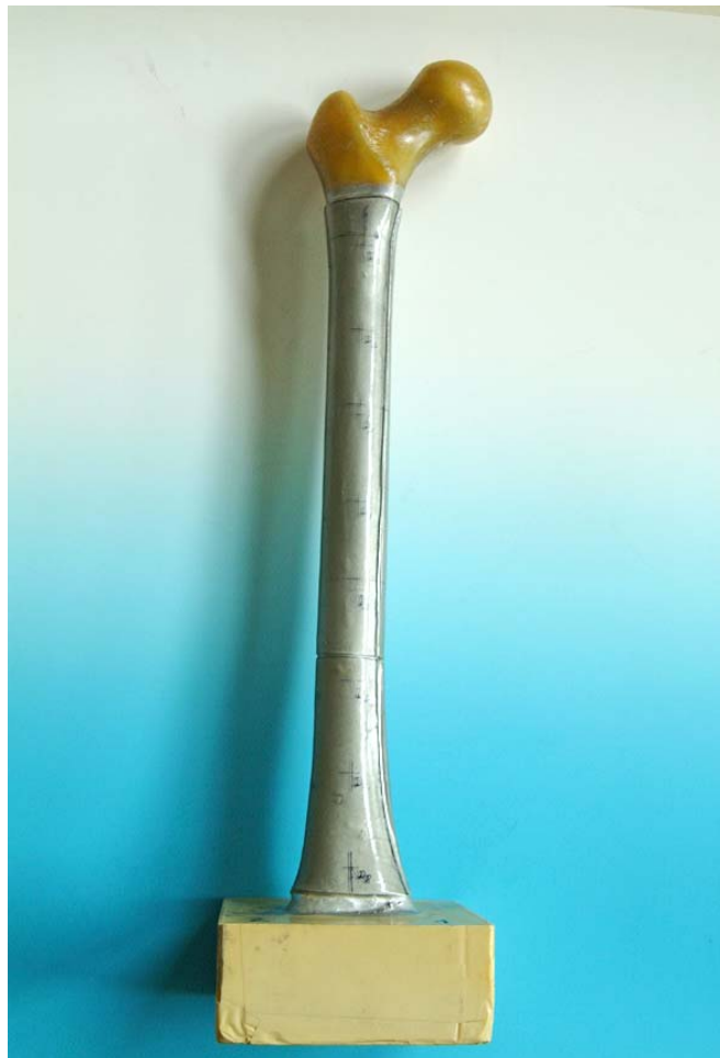
Abbildung 9: beschichtetes composite femur mit distaler Einbettung in nativem Licht, Ansicht von dorsal
