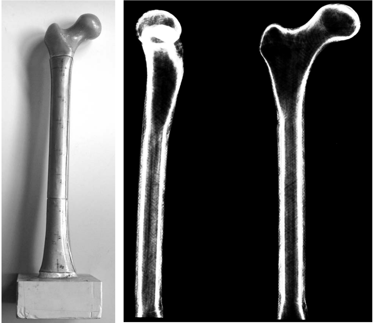
Abbildung 6: Composite femur: Darstellung nativ im beschichteten Zustand (links in s/w von dorsal) sowie im Röntgenbild in 2 Ebenen (rechts)
