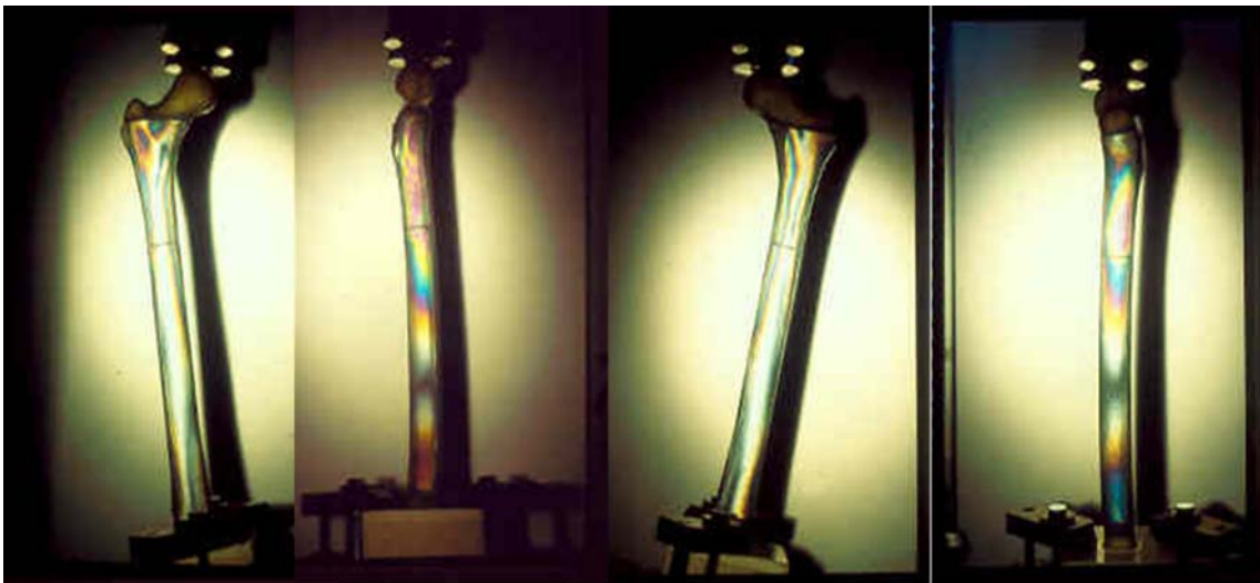
Abbildung 10 a-h (jeweils von links nach rechts in den Ansichten von dorsal, medial, ventral und lateral): Unresezierter Prüfkörper unter polarisiertem Licht. 10 a-d (obere Reihe) : 800 N Last, 0° Adduktion, 0° Antetorsion; 10 e-h (untere Reihe): 2400 N Last, 10° Adduktion, 0° Antetorsion. Unterschiede werden besonders deutlich im Vergleich der medialen und lateralen Aufsichten (10 b/f und 10 d/h).
