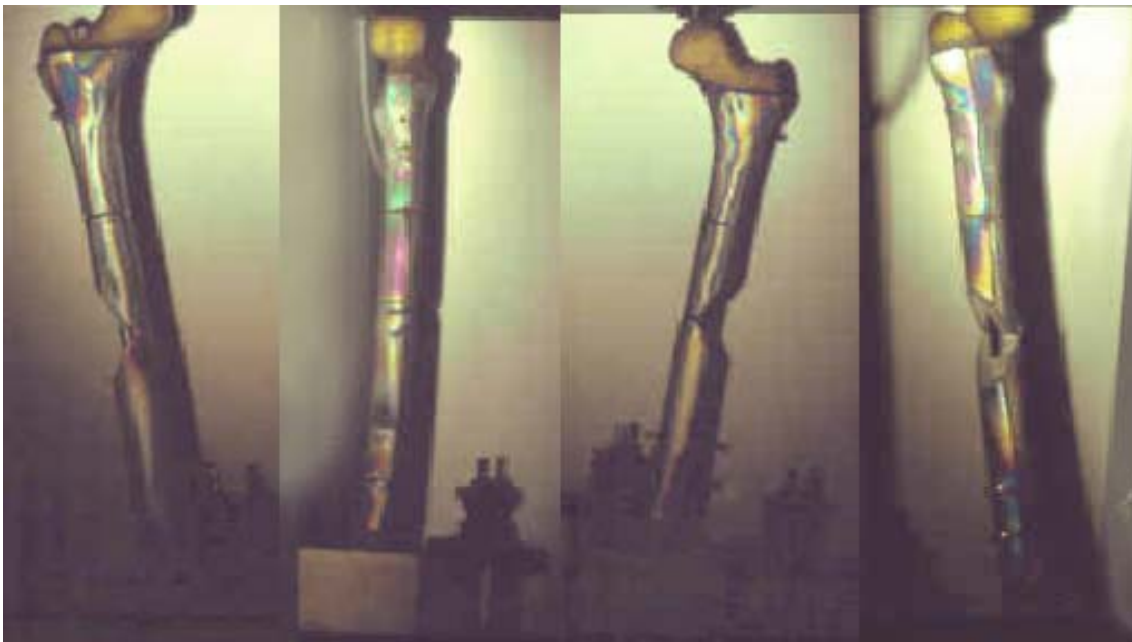
Abbildung 20 a-d (von links nach rechts, in den Ansichten von dorsal, medial, ventral und lateral): Composite femur mit lateralem 2/3 Keil, ICN mit 3 Nm Vorkompression, 2400 N Last, 10° Adduktion, 12° Antetorsion.
