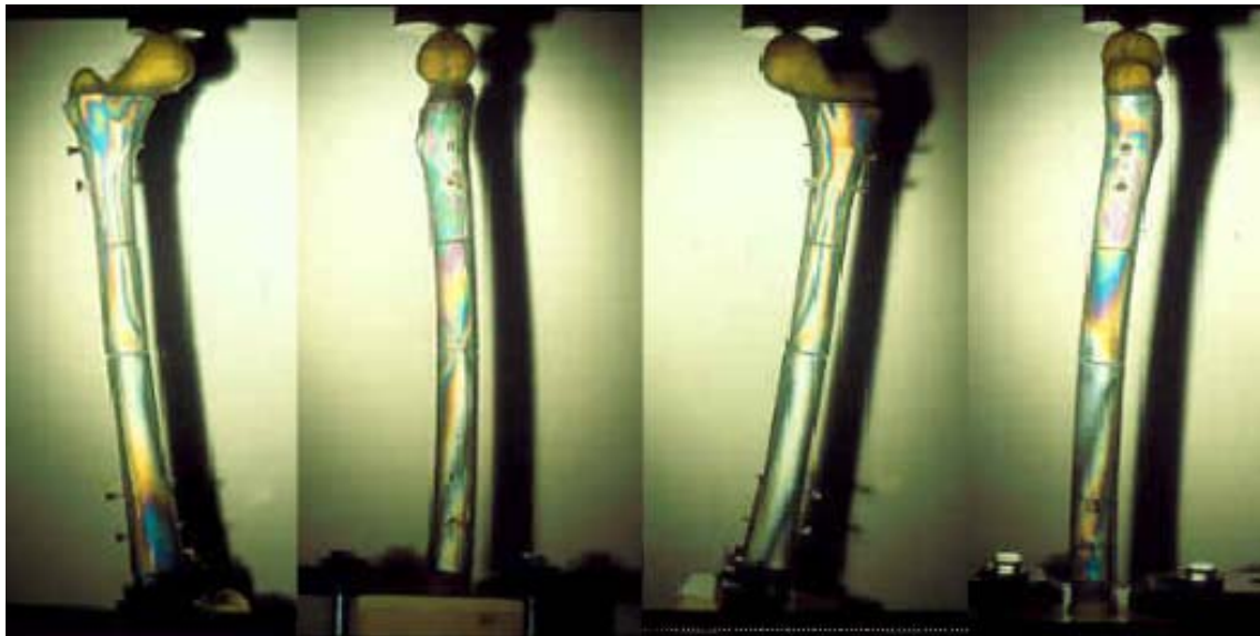
Abbildung 16 a-d (von links nach rechts, in den Ansichten von dorsal, medial, ventral und lateral): Statisch verriegelter ICN unter polarisiertem Licht mit 2400 N Last in 10° Adduktion, keine Antetorsion
