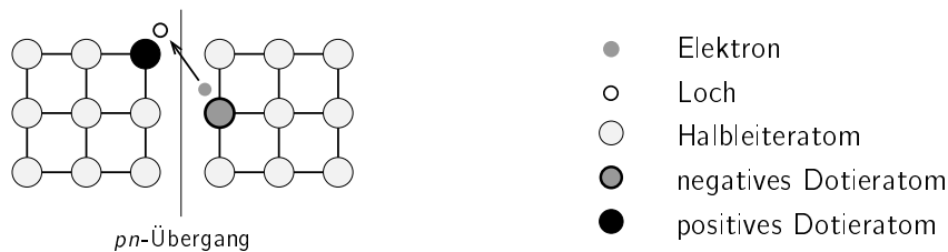
Abbildung 1.5: Modell für die zufallsabhängige Drift bzw. Diffusion eines Elektrons durch einen pn -Übergang, die Schrotrauschen verursachen.
