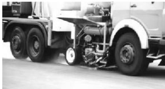
Bild 11: Messung von Reifeneigenschaften auf der Teststrecke [201]
