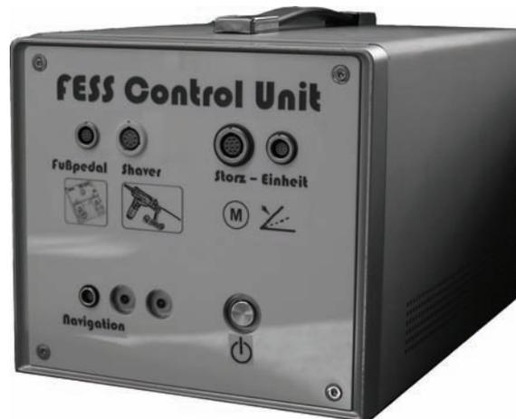
**Abbildung 27:** Die Steuerelektronik (hier in der Ausführung für FESS) kontrolliert die Leistung des Instruments und überwacht die Instrumentenabschaltung. Das Navigationssystem, die chirurgische Einheit, das Fußpedal und das Instrument werden an die Steuerelektronik angeschlossen.
