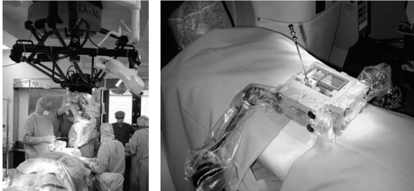
**Abbildung 19:** Links ist ein Roboter für die Kopfchirurgie (IIH), rechts ein miniaturisierter, autoklavierbarer Roboter dargestellt (Charité – Virchow Klinikum, Berlin).
