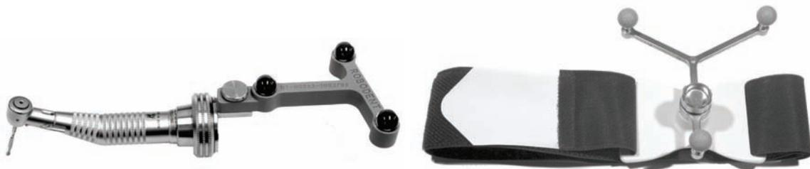
Abbildung 13: Links ist ein Bohrer für die dentalen Implantologie mit einem Instrumententracker (Firma RoboDent GmbH), rechts ist ein Patiententracker der Firma BrainLAB AG für die HNO-Navigation dargestellt.
