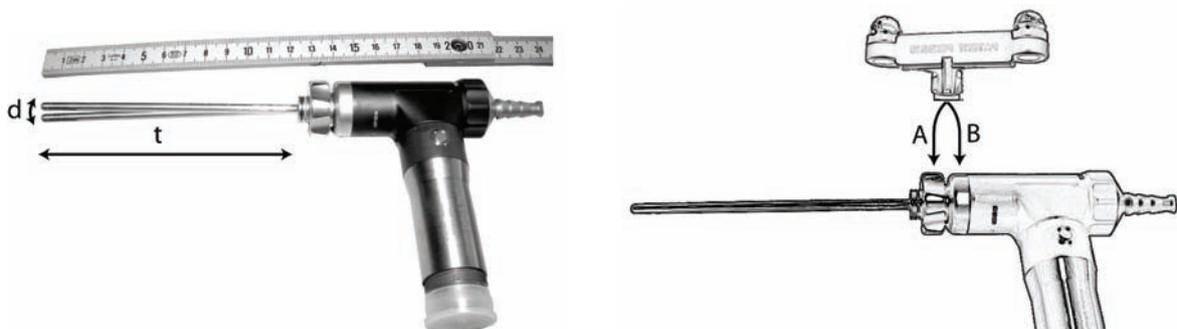
**Abbildung 34:** Links: Der Shaver wird in seiner gesamten Länge  $t$  eingesetzt, die geringe Steifigkeit der Befestigung der Shaverspitze am Shavergriff ermöglicht eine Auslenkung der Shaverspitze um  $d$ , rechts: bei der Befestigungsvariante A wird der Instrumententracker direkt an der Shaverspitze, bei der Variante B am Shavergriff befestigt.
