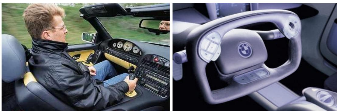
**Abb. 67:** „Steer-by-wire“-Konzepte von Mercedes (links) und BMW (rechts)
