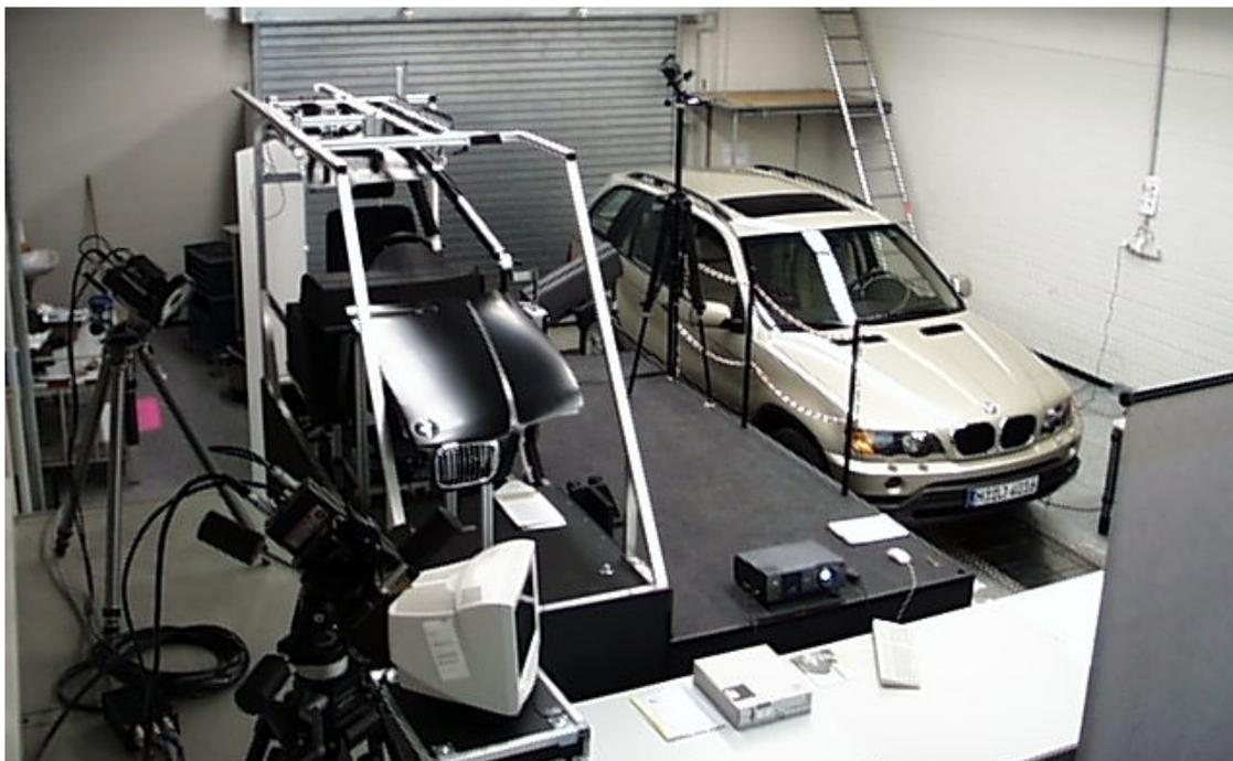
**Abb. 45:** Bewertung der Einstiegsverhältnisse an einem realen Fahrzeug und am VEMO
