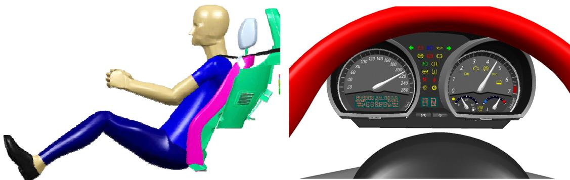
**Abb. 1:** Anwendungsbeispiele von digitalen Menschmodellen: Gurtverlauf (links) und die Sicht auf das Kombiinstrument (rechts)
