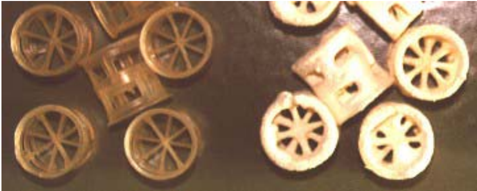
Abbildung 3-3: Links: Unbeschichtete Ralu ® -Ringe; Rechts: Silikonbeschichtete Ralu ® -Ringe
