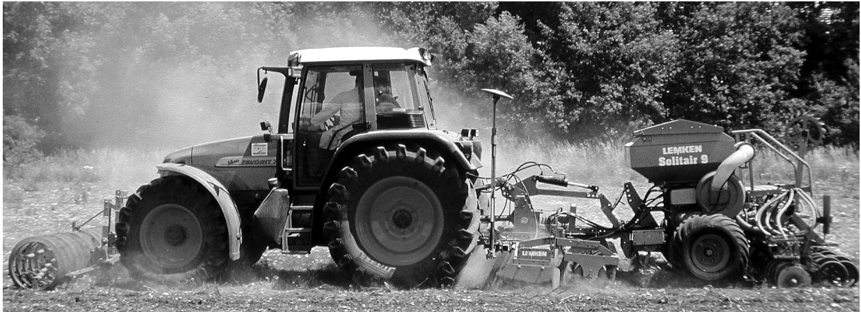
Bild 6-1: Automatisierte Traktor/Geräte-Kombination als Versuchsträger bei der Arbeit.
