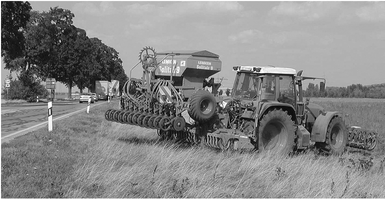
Bild 6-8: Versuchsgespann im aufgesattelten und aufgehobenen Zustand beim Wenden am Feldende (Vorgewende). Der Sicherheitsabstand zur Bundesstraße wird überwacht
