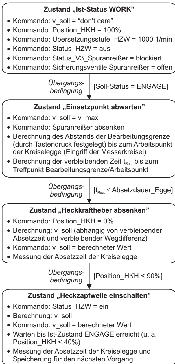
Bild 6-6: Zustandsdiagramm für den Statuswechsel von „Work“ (arbeitsbereit) nach „Engage“ (eingesetzt) der Kreiseleggensteuerung.
