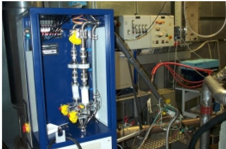
Abbildung 3-12: Bild des Mikrotunnels Mikrotroll 4 der Fa. NOVA, Schwarzenberg.
