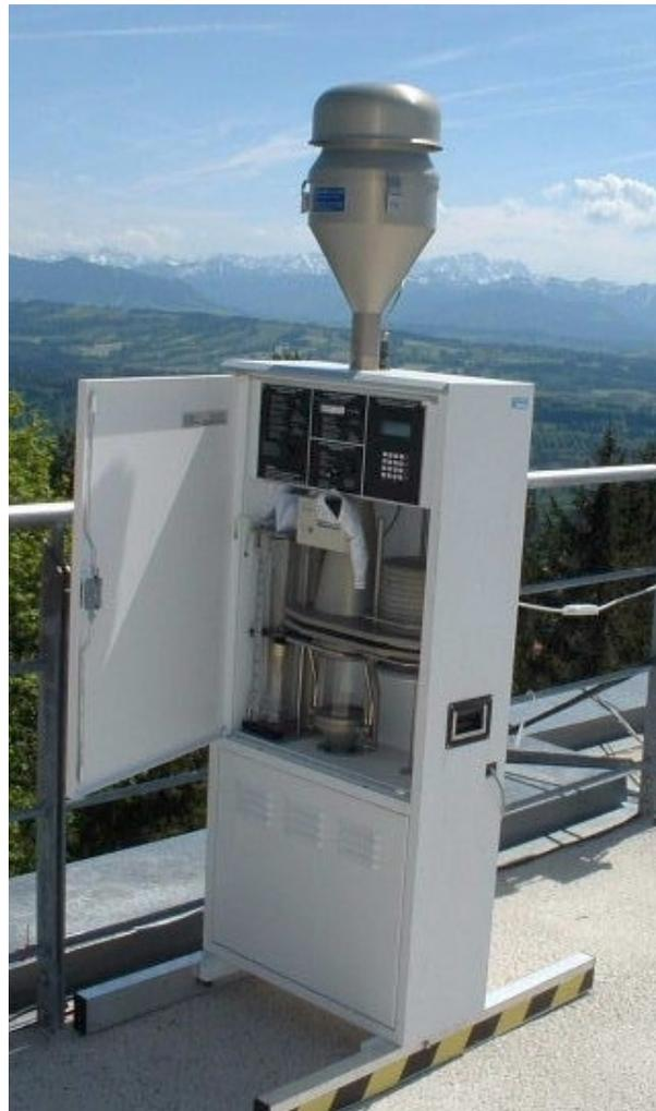
Abbildung 3-9: High-Volume-Sampler der Fa. Riemer auf dem HP.
