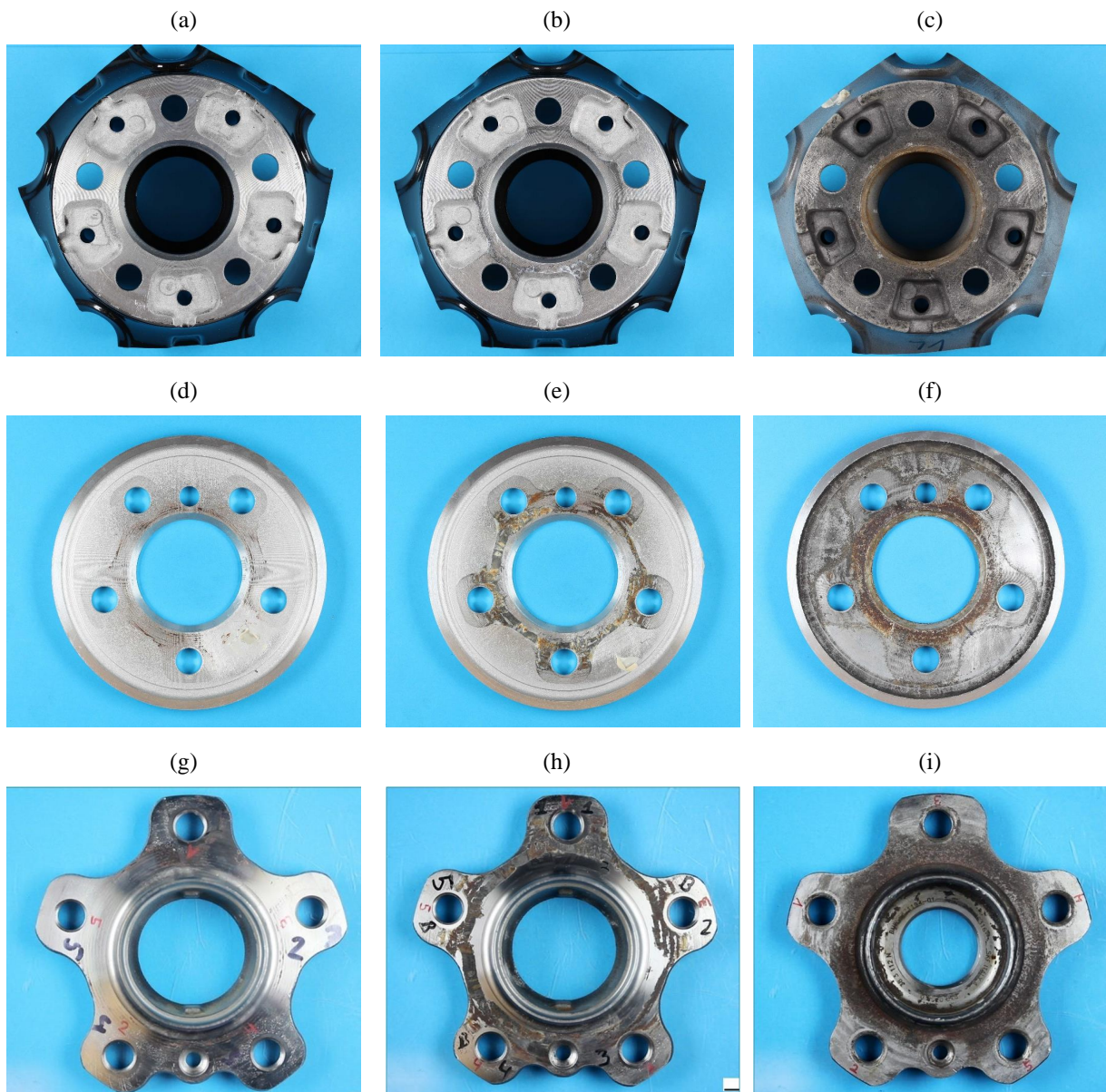
Abbildung 6.7: Fotos der Kontaktflächen bei Komponenten, die akustisch auffällig (Mitte) bzw. unauffällig (links) am Systemprüfstand waren. Komponenten aus einem bzgl. Tickern auffälligen Erprobungsfahrzeug sind zum Vergleich rechts dargestellt. (a), (b) und (c) zeigen die Anlagefläche des Rades zum Bremsscheibentopf; (d), (e) und (f) die Anlagefläche des Bremsscheibentopfes zum Radlager und (g), (h) und (i) die Anlagefläche des Radlagers zum Bremsscheibentopf.
