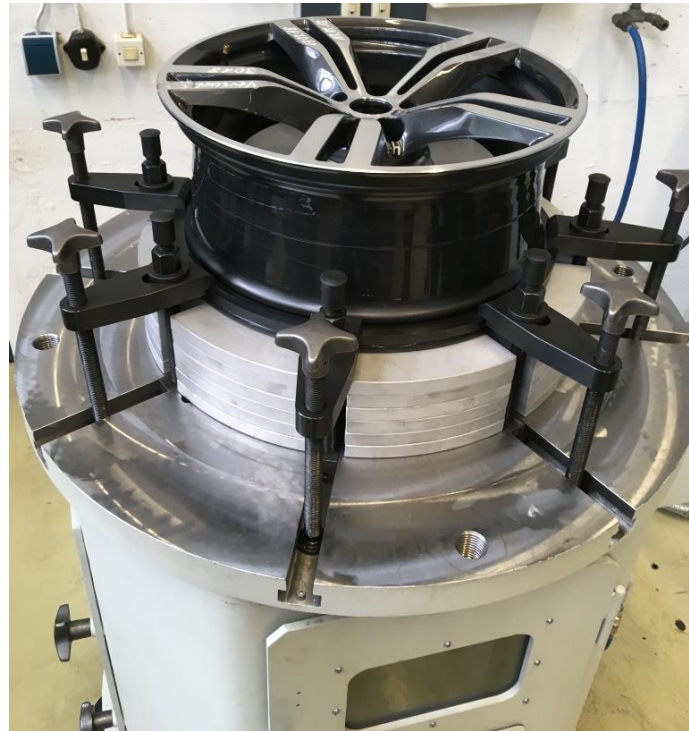
Abbildung 5.3: Foto des neu entwickelten Systemprüfstands für das Störphänomen Tickern. Quelle: IABG.
