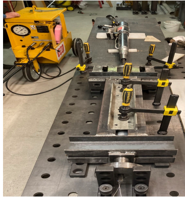
Abb. 2: Vorspannen der mit Glasfaser versehenen Litzen in einer Rahmenkonstruktion im DYWIDAG Prüflabor Leipzig
