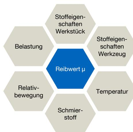
Abbildung 2.3: Einflussfaktoren auf den Reibwert während des Umformprozesses (modifiziert von Doege und Behrens (2016))
