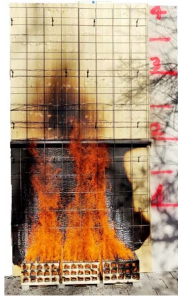
Abbildung 3.14 Brandeinwirkung durch drei 15 kg Holzkippen für den Referenzversuch Test 1 (8. Prüfminute)
