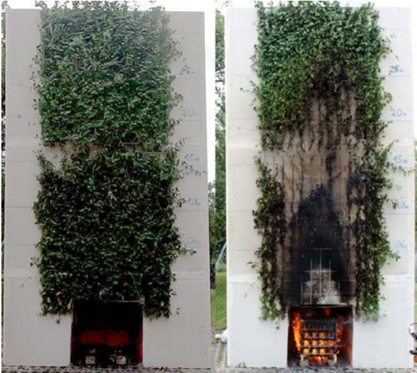
Abbildung PIV. 4 Versuch BV_Kriechspindel, vorher- und nachher; Fire test BV_Kriechspindel, before and after [9]
