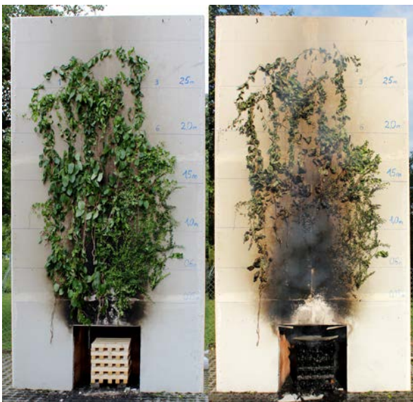
Abbildung PIV. 7 Versuch BV_Kiwi. Stauden und Kräuter, vorher- und nachher; Fire test BV_Kiwi. Stauden und Kräuter before and after [9]
