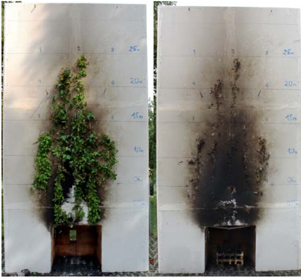
Abbildung PIV. 6 Versuch BV_Wilder Wein, vorher und nachher inkl. brennender Fackel; Fire test BV_Wilder Wein before and after incl. burning torch [9]
