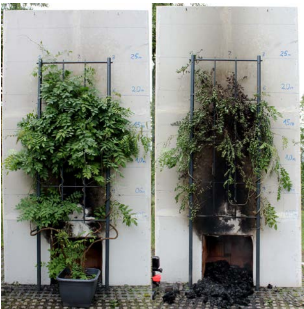
Abbildung PIV. 5 Versuch BV_Blauregen, vorher- und nachher. Fire test BV_Blauregen, before and after [9]
