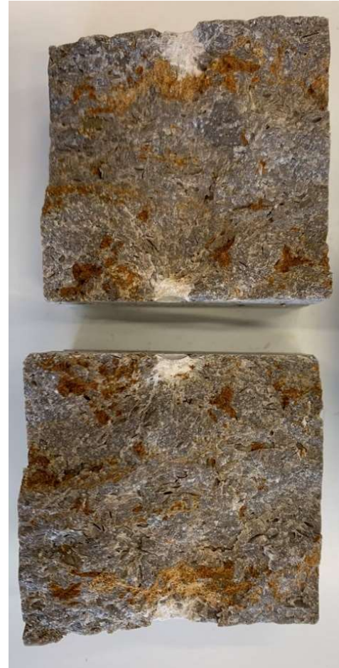
Bild 11: Beispiel an einem Probekörper aus Eiblstädter Muschelkalk nach einer Bestrahlungsdauer von 120 s.
