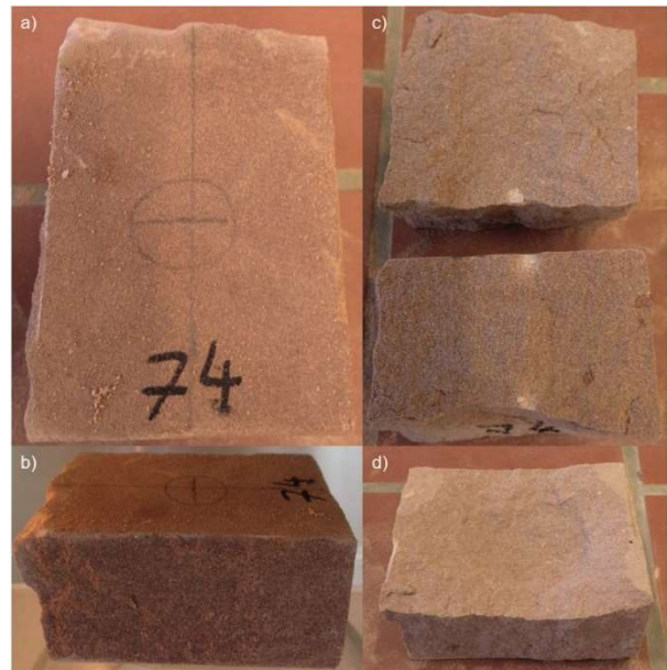
Bild 8: Beispiel Odenwälder Buntsandstein Bruchfläche der Probe nach Bestrahlung und nach Punktlastversuch a) Probe vor Bestrahlung von oben b) Probe vor Bestrahlung von der Seite c) Bruchfläche der Probe nach Bestrahlung und nach Punktlastversuch d) Probe nach Bestrahlung von oben
