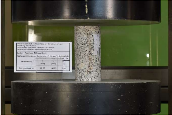
Bild 7: Einaxialer Druckversuch am Tittlinger Granit
