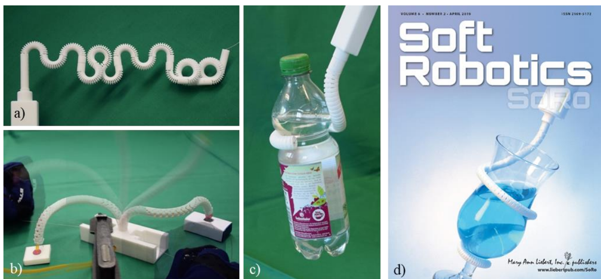
Abb. 9: Verschiedene Funktionsmuster der Formgedächtnisstrukturen: a) Struktur bildet das Lehrstuhlakronym „MiMed“, b) Erstes Beispiel für ein Pick-and-Place -System, c) Formspezifischer Greifer für eine 0,5l PET-Flasche, d) Formspezifischer Greifer für ein Cocktailglas ( Soft Robotics Journal , Vol. 6, Issue 2, April 2019).
