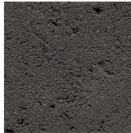
Abbildung 29: Oberfläche einer dunklen Betonsteinprobe ( \alpha = 0,913 ) (Bildquelle: [86])
