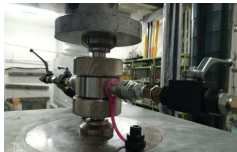
Abb. 12-A32: Triaxialzelle im Versuchsstand während dem Abscheren
