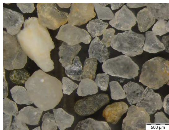
Abb. 12-A15: Mikroskopie der Körnung 8/16
