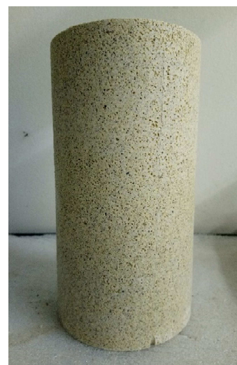
Abb. 12-A18: Probekörper nach Ausbau und Zuschnitt
