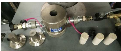
Abb. 12-A34: Triaxialzelle, Kugelgelenke und Probekörper
