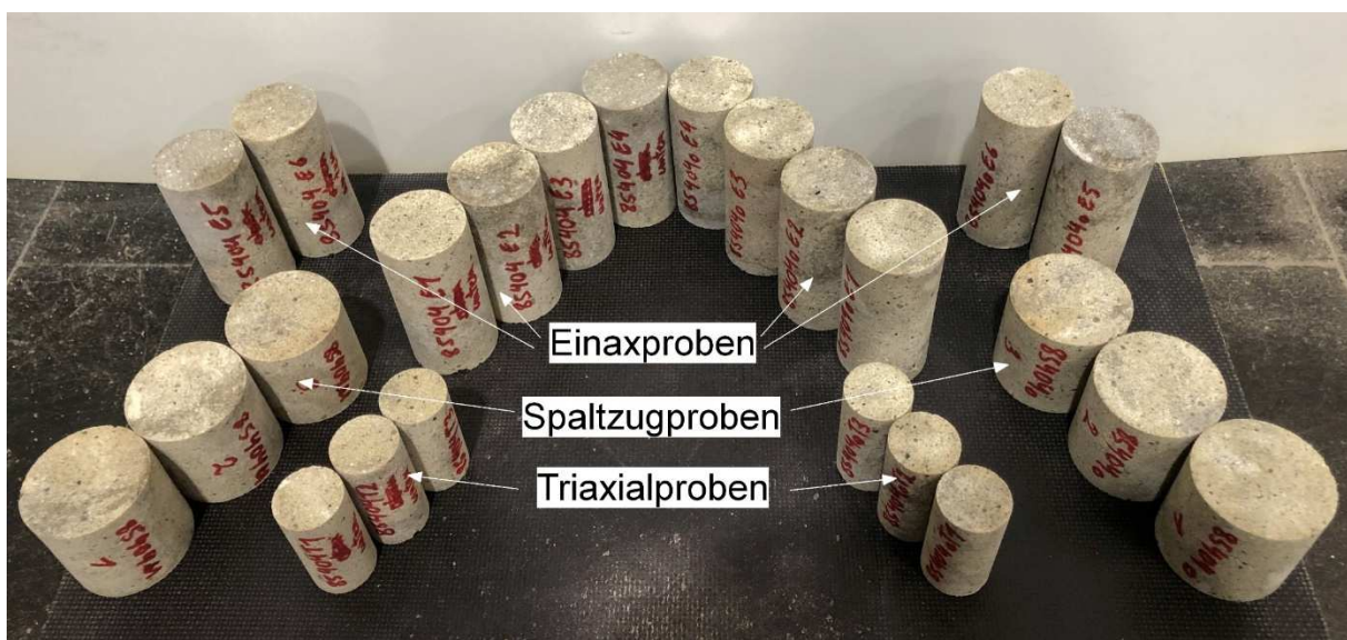
Abb. 12-A25: aus Injektionskörper IK5 gewonnene Probekörper (BAMERNI 2020)
