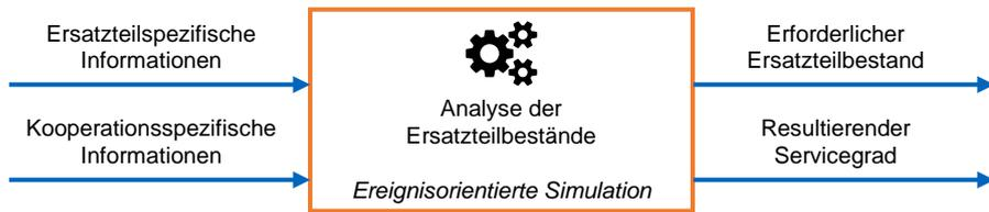
Abbildung 4-5: Modul Analyse der Ersatzteilbestände mit erforderlichen Funktionseingängen und Funktionsausgängen
