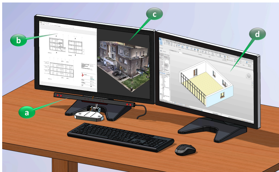
Abbildung 1: Versuchsumgebung (a: Eyetracker, b: PDF-Viewer, c: Pointcloud-Viewer, d: BIM-Software)
