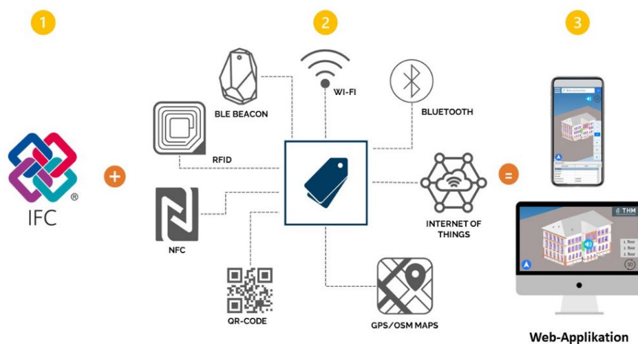
Abbildung 2: Workflow zur Integration von RTLS- und IoT-Technologien in digitale Bauwerks-Informations-Modellen und physische Bauelementen
