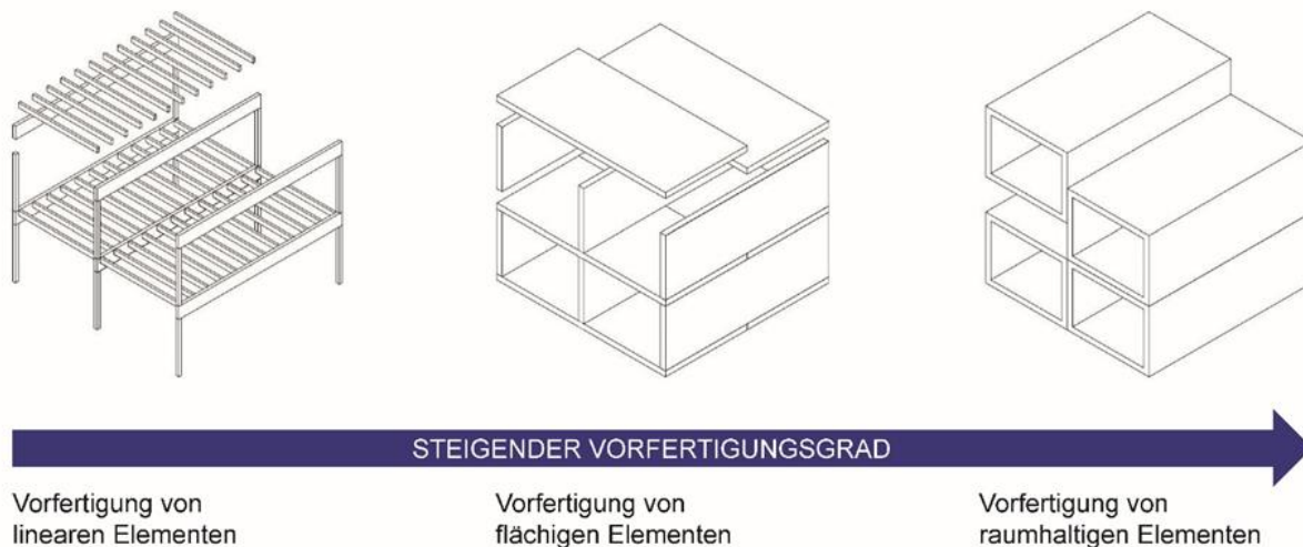
Abbildung 1: Grad der Vorfertigung im Holzbau
