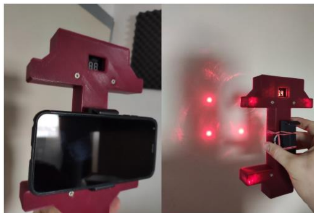
Abbildung 1: Referenzgerät zur Erzeugung eines optischen Maßstabs
