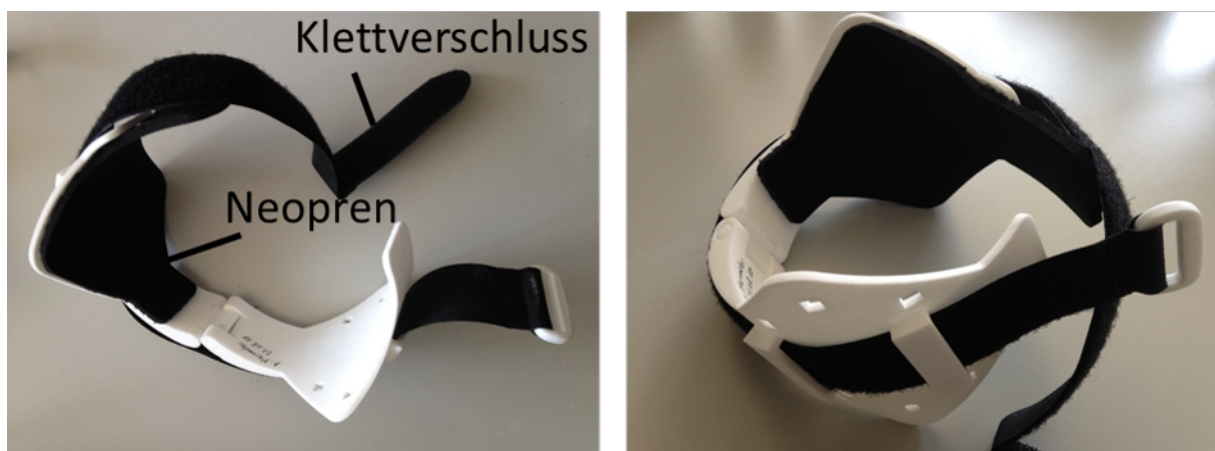
Abbildung 72: Zweiter Prototyp der Schale zur Messung der Kniebeugebewegung. Die angepasste Form ermöglicht eine bessere Haftung am Bein des Patienten und reduziert das Gewicht der Schale.
