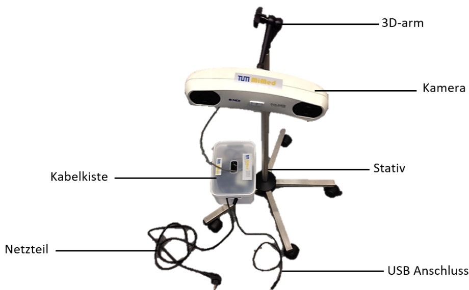
Abbildung 74: Darstellung der Stereokamera zur Messung der Beugebewegung des Patienten.
