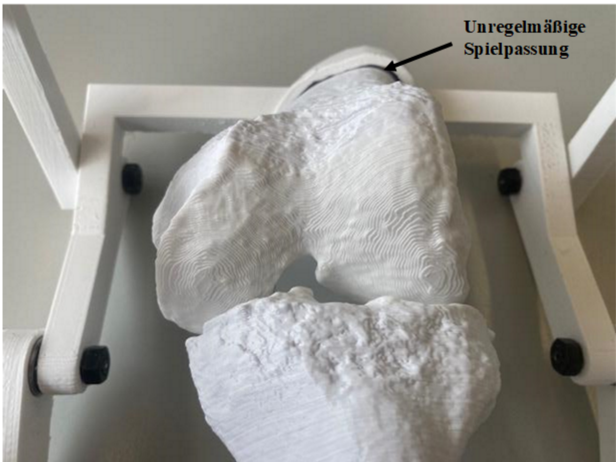
Abbildung 84: Beispiel für einen Passungsfehler bei der Konstruktion des Mechanismus. Dadurch kommt es zu einer Ungenauigkeit bei der Bewegung des Modells.
