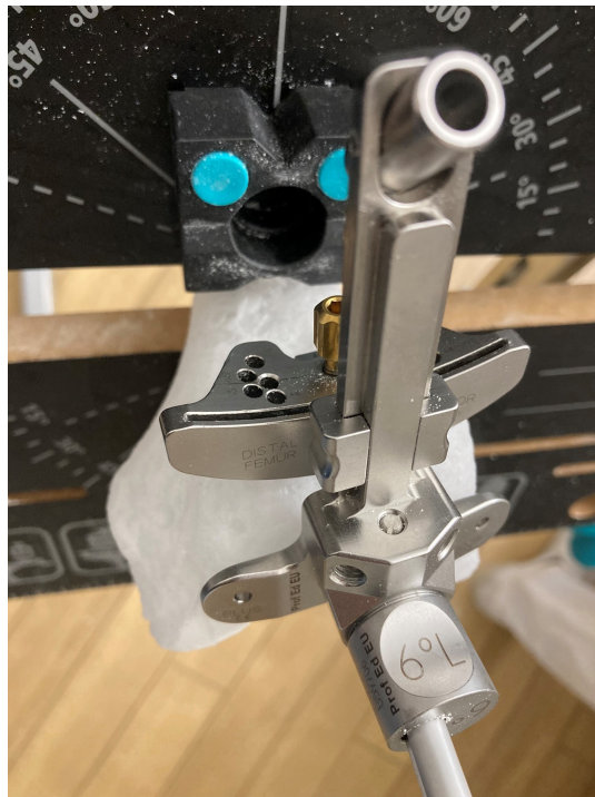
Abbildung 11: Schnittschablone (TC-PLUS PRIMARY Set von Smith & Nephew (London, United Kingdom)) für das Femur auf eine Kunststoff-Knochenkopie eines Patienten gesetzt.
