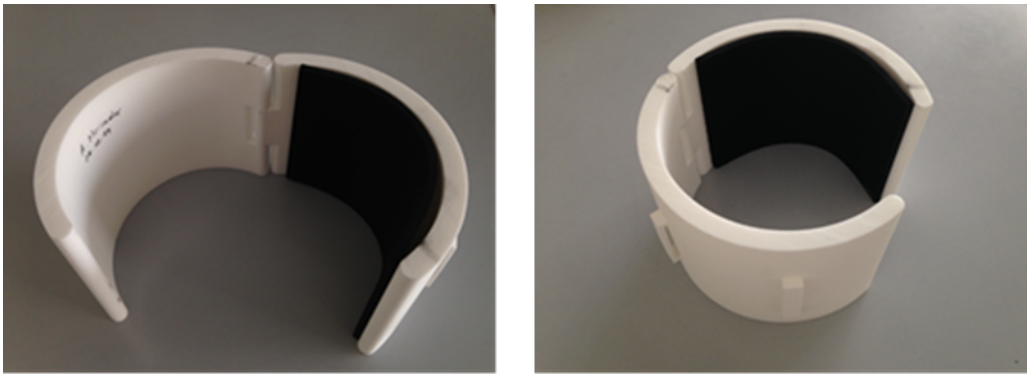
Abbildung 71: Erster Prototyp der Schale zur Messung der Kniebeugebewegung. Es handelt sich um eine zylindrische Form (Dicke 1 cm).
