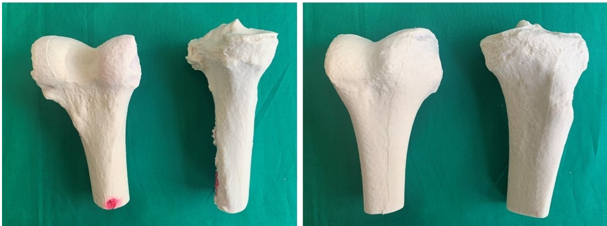
Abbildung 14: Beispiel für am Lehrstuhl erstellte Knochenmodelle. Das verwendete Material ist für die Oberfläche G27 Biresin und für den Innenraum Bioresin.
