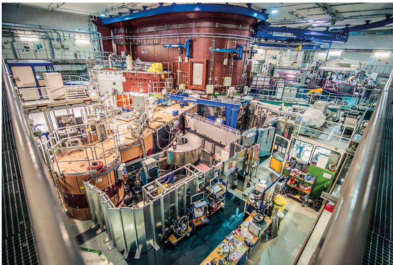
Blick in die Experimentierhalle des FRM II. Das Besondere an dieser Neutronenquelle ist, dass sie ganz individuell auf die Erfordernisse des jeweiligen Experiments zugeschnittene Neutronen bereitstellt und damit eine Vielzahl unterschiedlichster Messungen erlaubt. © Volker Lannert/DAAD
