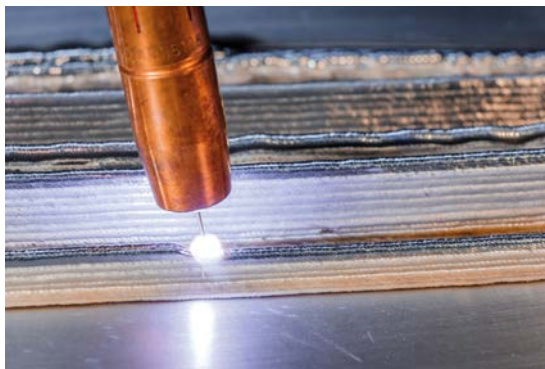
Lichtbogen- und drahtbasierte additive Fertigung © iwbt/TUM
