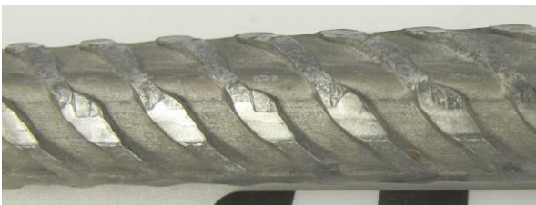
Abbildung 1: Betonstahl der Oberflächenzustandsklasse 3 (Ringmaterial, Durchmesser 16 mm)
