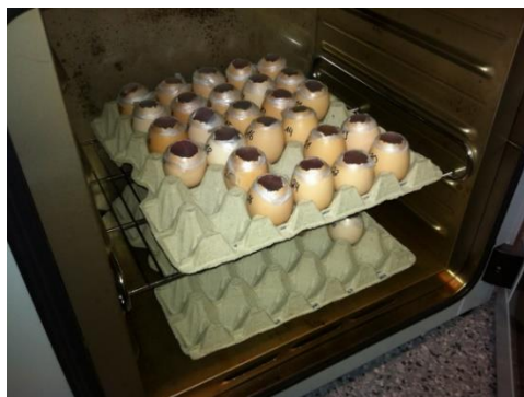
Abbildung 4: Versuchsaufbau im Inkubator. Mit Parafilm verschlossene Eier werden bei 37 °C inkubiert.
