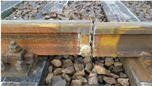
Abb. 36: Beispiel eines Schienenbruchs im Bereich einer Schienenschweißung
