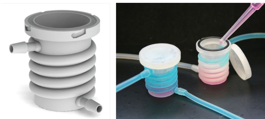
Abbildung 56: Rendering des ersten Designmusters des Bioreaktors inklusive Temperier-Ring (links). 3D-gedruckter Bioreaktor mit Dichtungsring, Deckel und Zellkulturmedium im Inneren. Der Temperiererring ist mit einer bläulich-gefärbten Flüssigkeit durchströmt.
