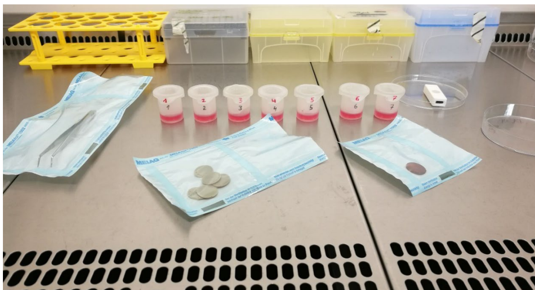
Abbildung 65: Versuchsaufbau zur Untersuchung, ob mit den selbst entwickelten 3D-gedruckten Bioreaktoren Zytotoxizitätsuntersuchungen durchgeführt werden können.
