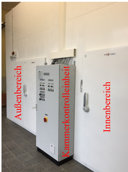
(b) Vorderansicht der Differenzklimakammer.
