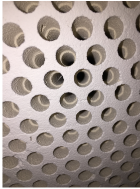
(a) Frontansicht des prototypisch hergestellten, solar-selektiven Wärmedämmsystems.
