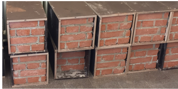
(b) Im Labor hergestellte Grundkörper, die mit verschiedenen Dämmsystemen versehen werden können.
