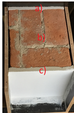
Abbildung 3.4: Ungedämmte Bestandwandprobe (WK1).
