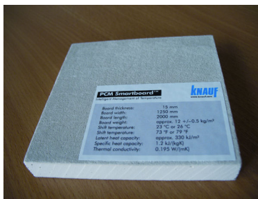
(a) Gipsbauplatte von Knauf mit rund 30 wt% mikroverkapseltem PCM.
