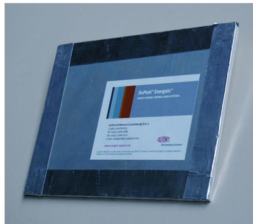
Abbildung 2.15: PCM-Verbundplatte DuPont™ Energain® mit einem PCM-Anteil von 60 wt%. Abbildung entnommen aus [105].
