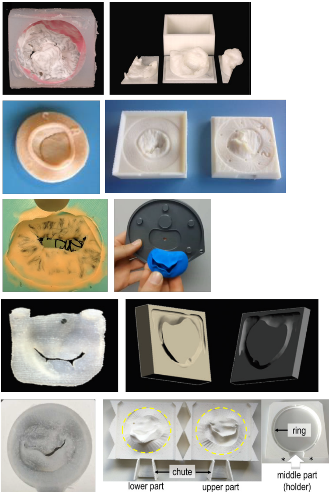
Abbildung 18: Aus Silikon gegossene, flexible Mitralklappenrepliken mit den zugehörigen 3D gedruckten Gussformen von Sardari Nia et al. (2017), Ilina et al. (2017), Ginty et al. (2017), Premyodhin et al. (2018) und Engelhardt et al. (2018) (von oben nach unten).
