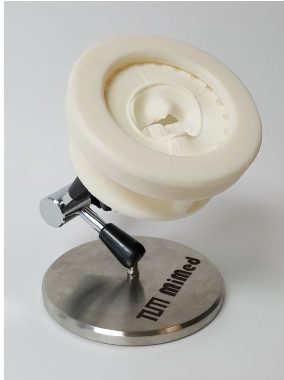
Abbildung 34: Eine Mitralklappenreplik in ihrer Halterung.
