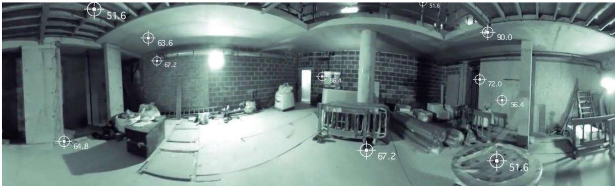
**Abbildung 9:** Umgebungstracking für die automatische Vorregistrierung (Leica Geosystems AG 2020a)
