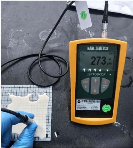
Abbildung 7.5: Trockenschichtdickenmessung Leptoskop 2042 Karl Deutsch.
