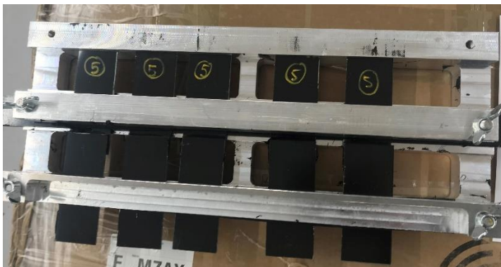
Abbildung 5.24: Prüfkörper nach DIN EN 1465 in der Aushärtevorrichtung
