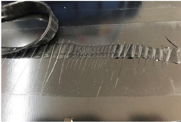
Abbildung 5.23: Peel Off Test Klebstoffraupe auf einer KTL Substratoberfläche mit aktivierten Haftvermittler.
