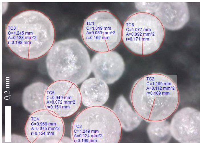
Abbildung 5.8: Messung der Kapseldurchmesser.
