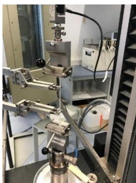
Abbildung 7.7: Zugprüfmaschine BTC-EX MULTI.PAC2 mit Extensometer der Firma ZwickRoell GmbH & Co. KG.
