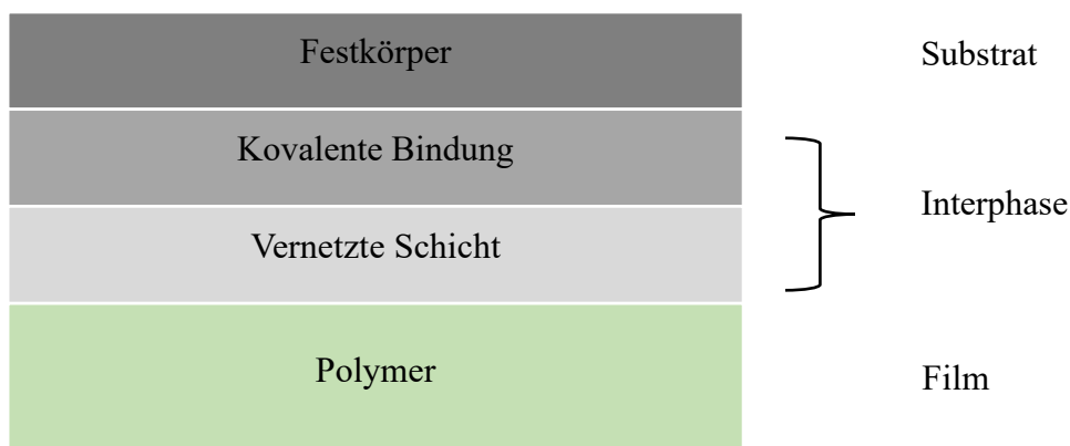
Abbildung 3.3: Schematisches Modell der Grenzfläche zwischen den Kontaktpartnern. [25]
