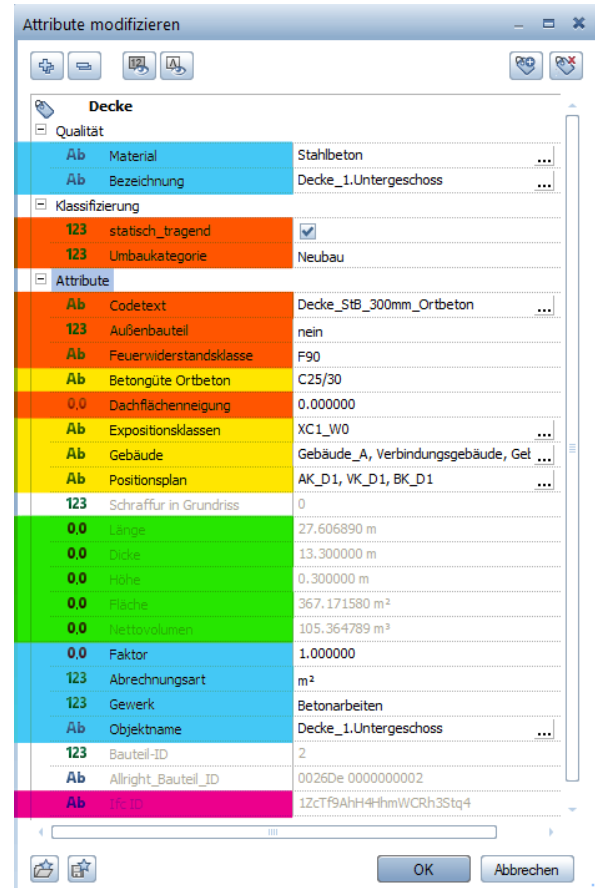
Abbildung 3.7: Attribute der Allplan-Funktion Decke im Fall einer Bodenplatte (links) bzw. Decke (rechts)
