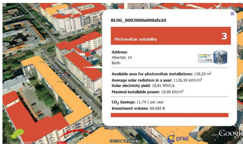
Abbildung 8 Links: Analyse des Sonnenpotentials von Hausdächern [22]
