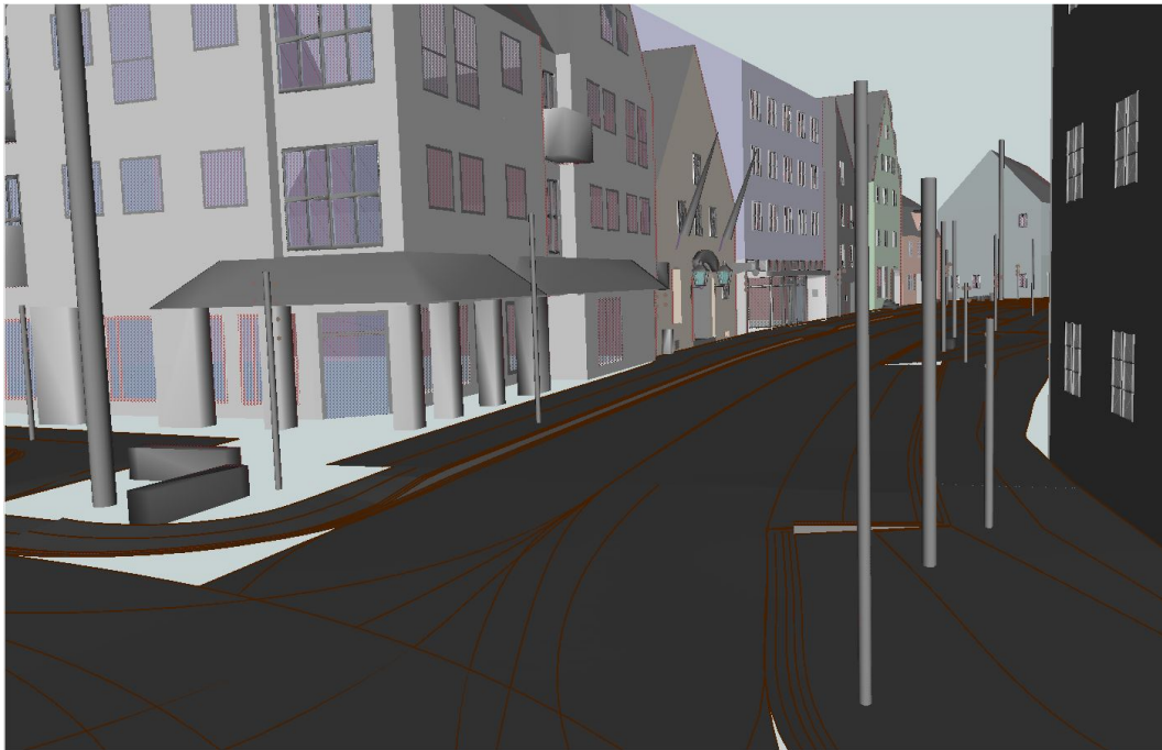
Abbildung 7 Gebäudemodell in LoD3 mit zusätzlichem Straßenraummodell. Die Szene enthält den gleichen Straßenabschnitt wie in Abbildung 2 nur von einem anderen Standpunkt aus (vgl. hierzu: Abbildung 2 Links mit Abbildung 3 Bildmitte: beiges Gebäude mit Laternen und Fahnenmästen)
