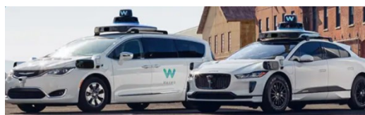
Abbildung 2 Fahrzeuge mit zusätzlichen Sensoren der Firma Waymo [7]
