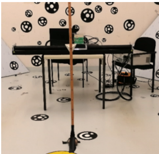
Abbildung 3.5: Messaufbau zur Bestimmung der Kalibrierparameter ( links ), Prinzipskizze des Messaufbaus aus Sicht der Referenzantenne R_{x_1} ( rechts ).
