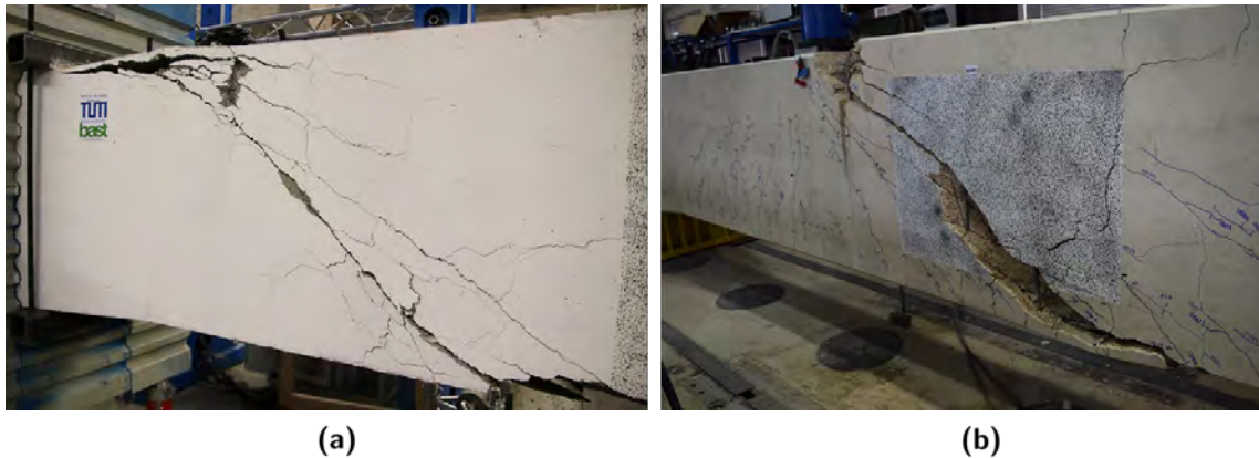
Abbildung 3.8: Vergleich der Rissbilder (kritischer Schubriss im Feldbereich) für (a) dem Durchlaufträger-Teilsystem bei Prüfung im Substruktur-Versuchsstand [Schramm et al., 2019a] und (b) einen ganzen Durchlaufträger (Quelle: Martin Herbrand, RWTH Aachen)
