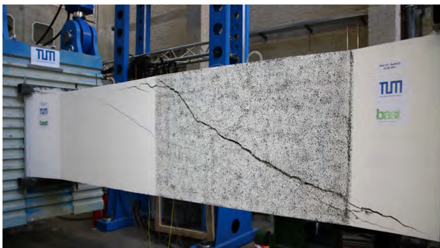
Abbildung 3.19: Bruchbild des Versuchs R2-gB; Ansicht von der Seite mit optischem Messfeld, links: Achse Feld, rechts: Achse Stütze
