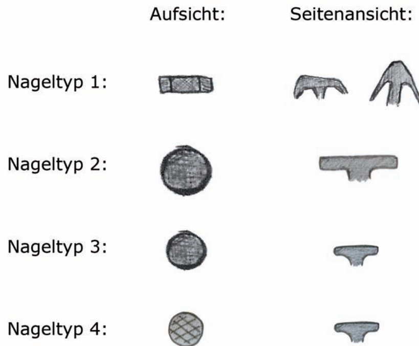
Abb. B 124: Auflistung der differenzierbaren, vorkommenden Nageltypen (siehe Kartierungen auf folgenden Seiten)
