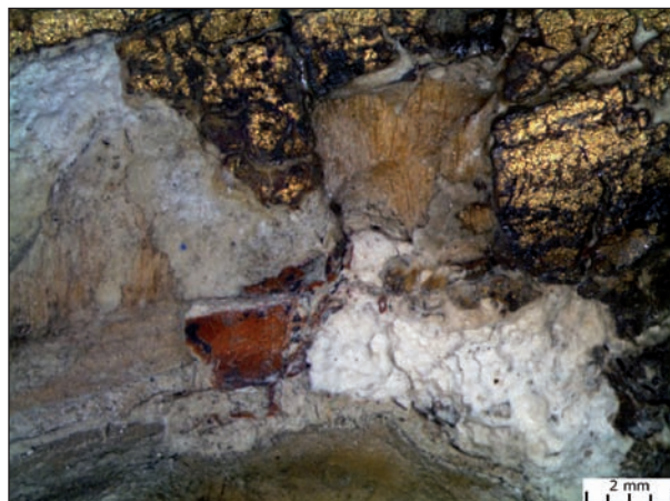
Abb. B 152: Bischof A 346, Mikroskopaufnahme aus Fassung des Mitrazierbesatzes: Erstfassung (Versilberung) unter der heutigen Sichtfassung (Vergoldung)
