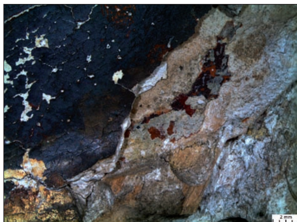
Abb. B 154: Bischof A 351, Mikroskopaufnahme aus Fassung der Mitra: Erstfassung (Versilberung) unter der heutigen Sichtfassung (Versilberung)
