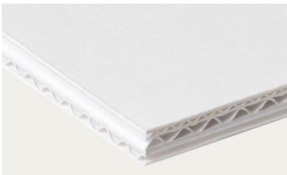
Abb. 219: Dreifache Wellpappe aus alterungsbestandigem Karton (Wellenhohe 1,5, 3,0 und 3,0 mm, Deckschicht aus Museumskarton mit 365 g/m<sup>2</sup>, Gesamtdicke 8,0 mm, kreuzweise verleimt)
