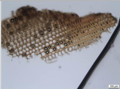
Merkmale im Querschnitt: Nadelholz, dickwandige Spätholztracheiden und dünnwandige Frühholztracheiden, abrupter Übergang vom Früh- zum Spätholz
