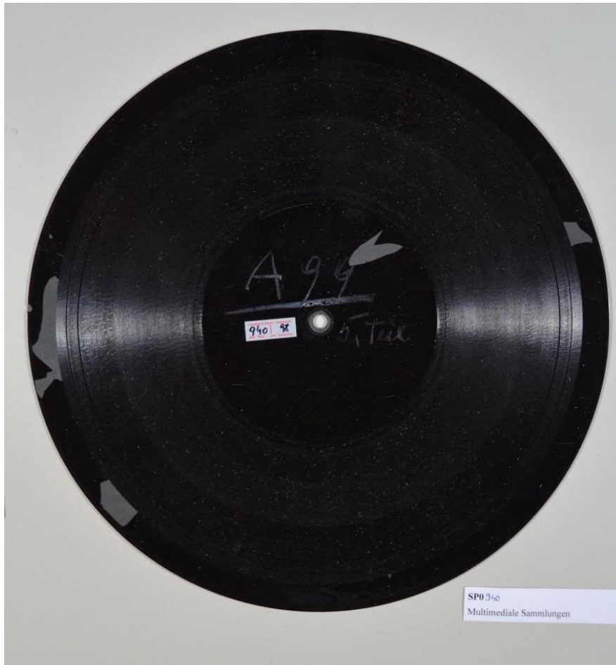
Abb. 45 Acetat-Platte, graue Stellen = Ausbrüche der Lackschicht über dem Metallkern
