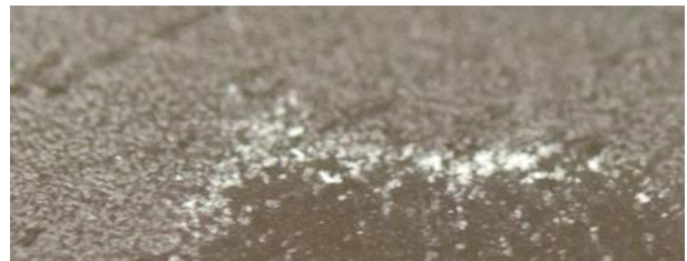
Abb. 33 Kristalline Ablagerungen auf Decelithplatte
