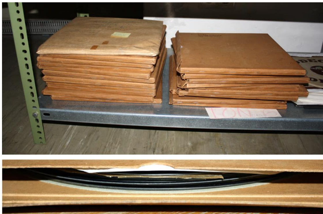
Abb. 9 +10 Decelithplatten in Kartonagen (oben) = Lagersituation seit ca. 2007; Gepresster Plattenstapel in Kartonage (unten)
