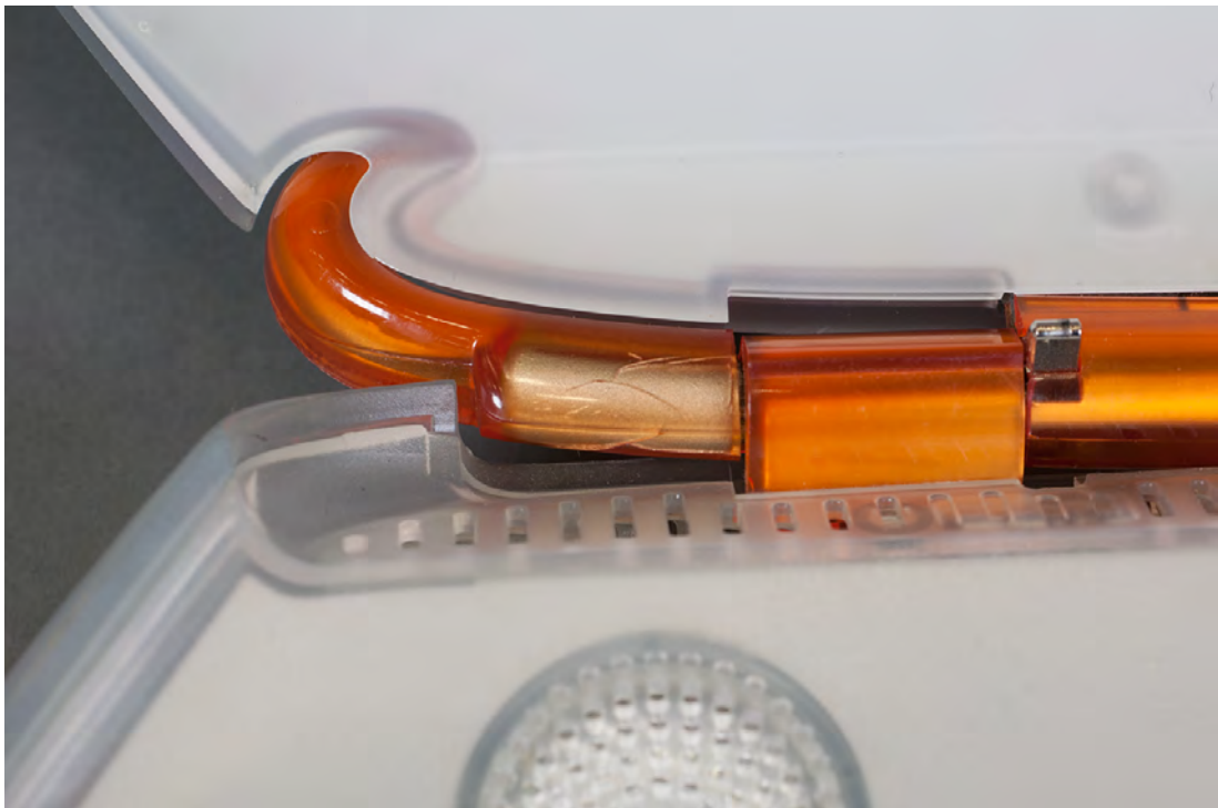
Abbildung A.11: Risse im Tragegriff nahe des Scharniers.
