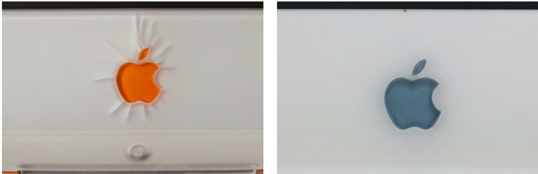
Abbildung 3.3: Ausgeprägtere Rissbildung entlang des Apple-Logos an iBook 'Tangerine' (links) im Gegensatz zu schwächerer Rissbildung an iBook 'Graphite' (rechts).
