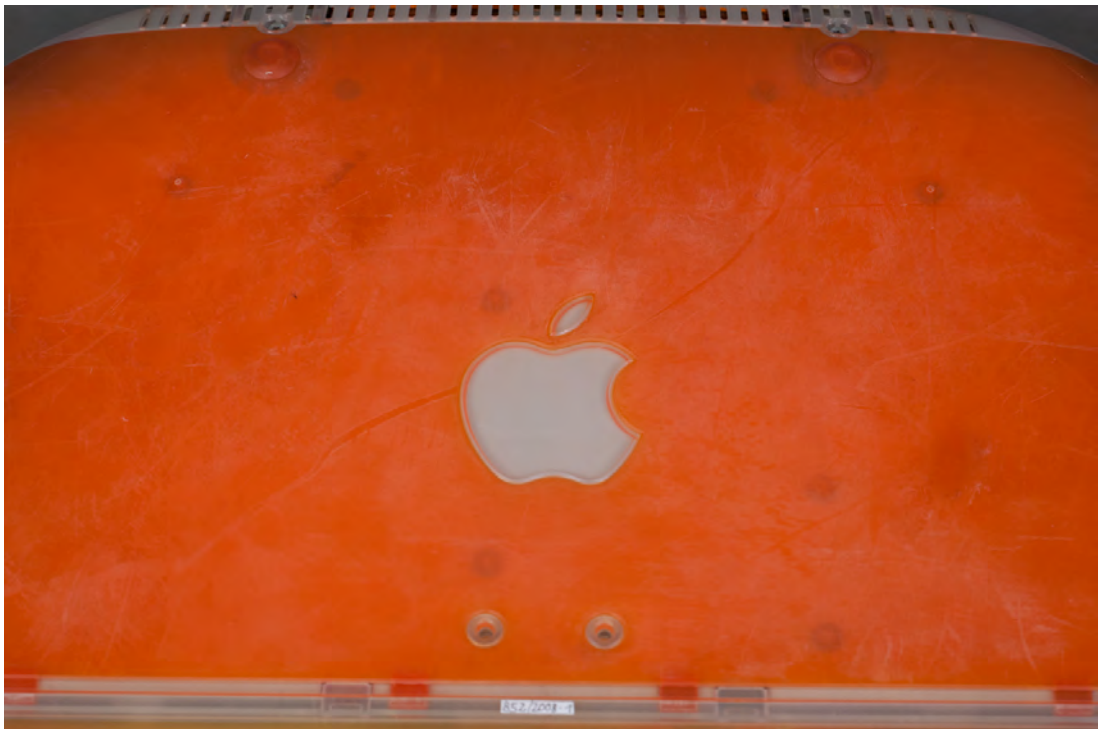
Abbildung A.15: Kratzer und Abrieb an der Unterseite.
