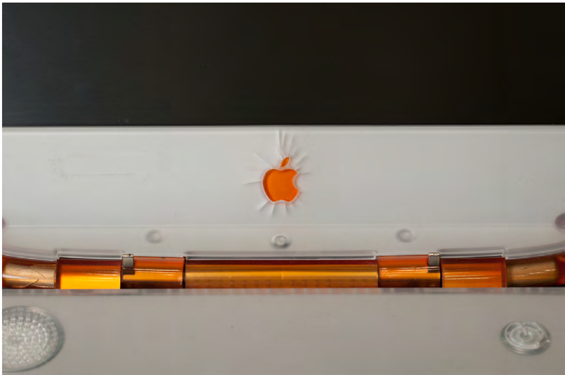
Abbildung A.9: Spannungsriss unterhalb des Displays.
