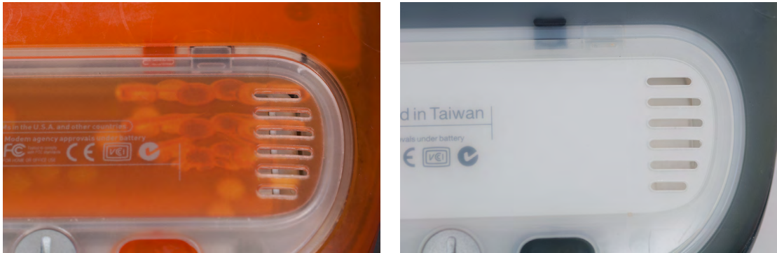
Abbildung 3.5: Transparent orangene Farbausführungen des Akkufachs bei iBook 'Tangerine' (links) im Gegensatz zu weiß opaker Farbigeit bei iBook 'Graphite' (rechts). iBook 'Tangerine' zeigt Farbveränderungen entlang der Lüftungsschlitze.
