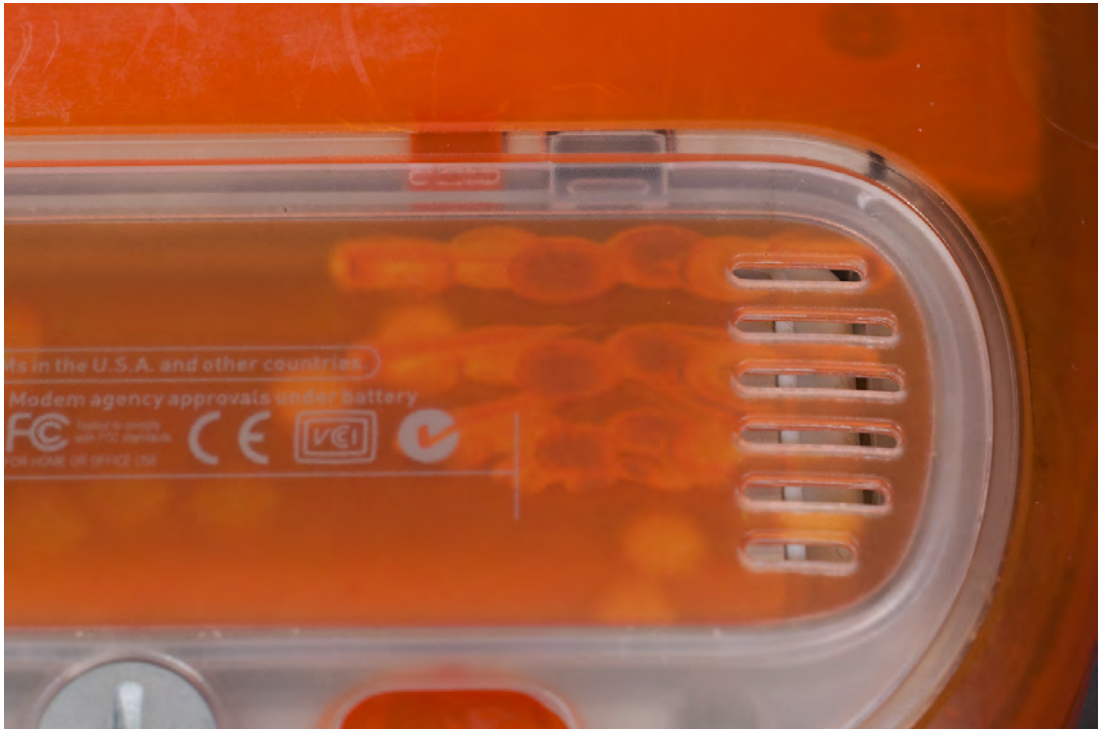
Abbildung A.14: Farbveränderungen am Akkufach nahe der Lüftungsschlitze.
