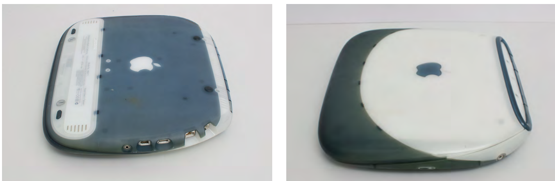
Abbildung 3.22: Vergleich der stärker vergilbten PUR-Gummierung an der Oberseite im Gegensatz zur weniger stark vergilbten Unterseite von iBook 'Graphite'.
