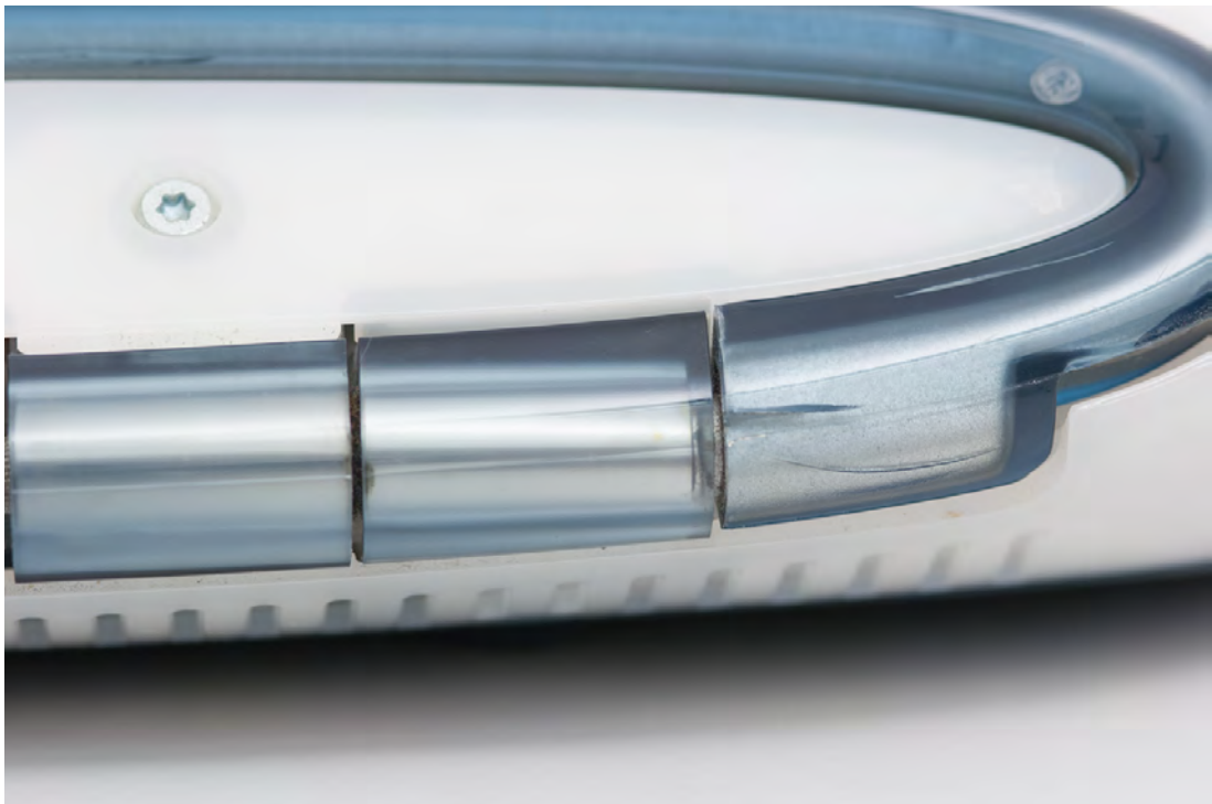
Abbildung A.27: Risse im Tragegriff nahe des Scharniers.
