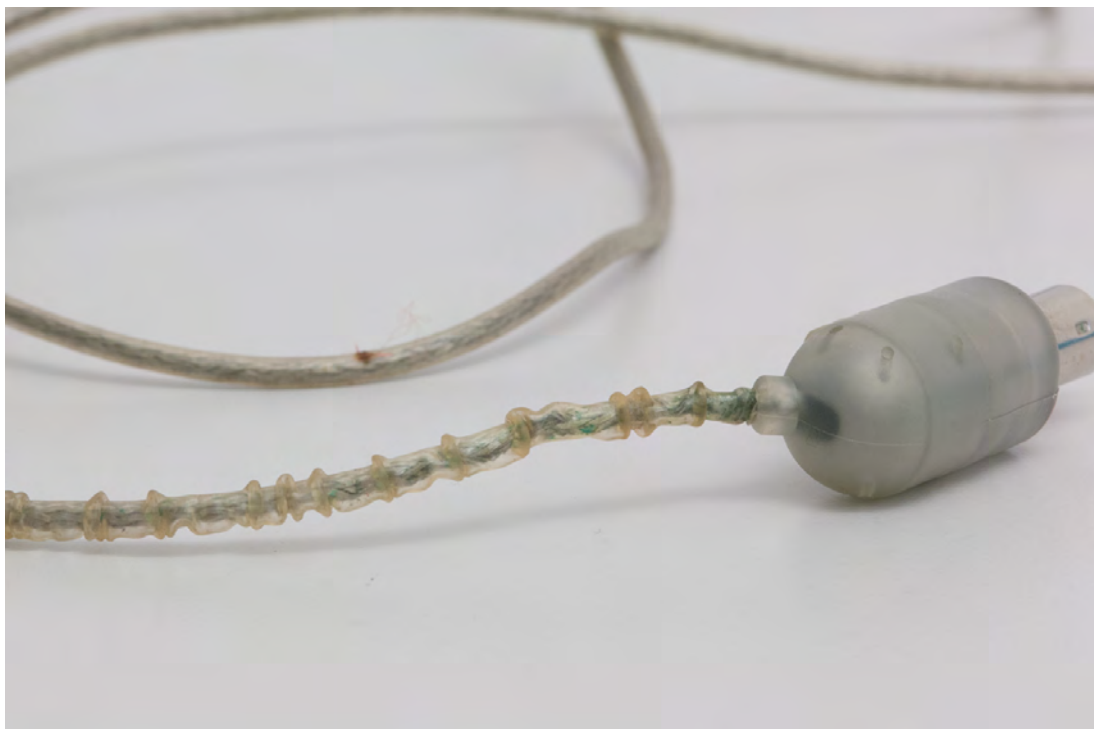
Abbildung A.35: Strukturveränderung an der Kabelummantelung des Netzteils.
