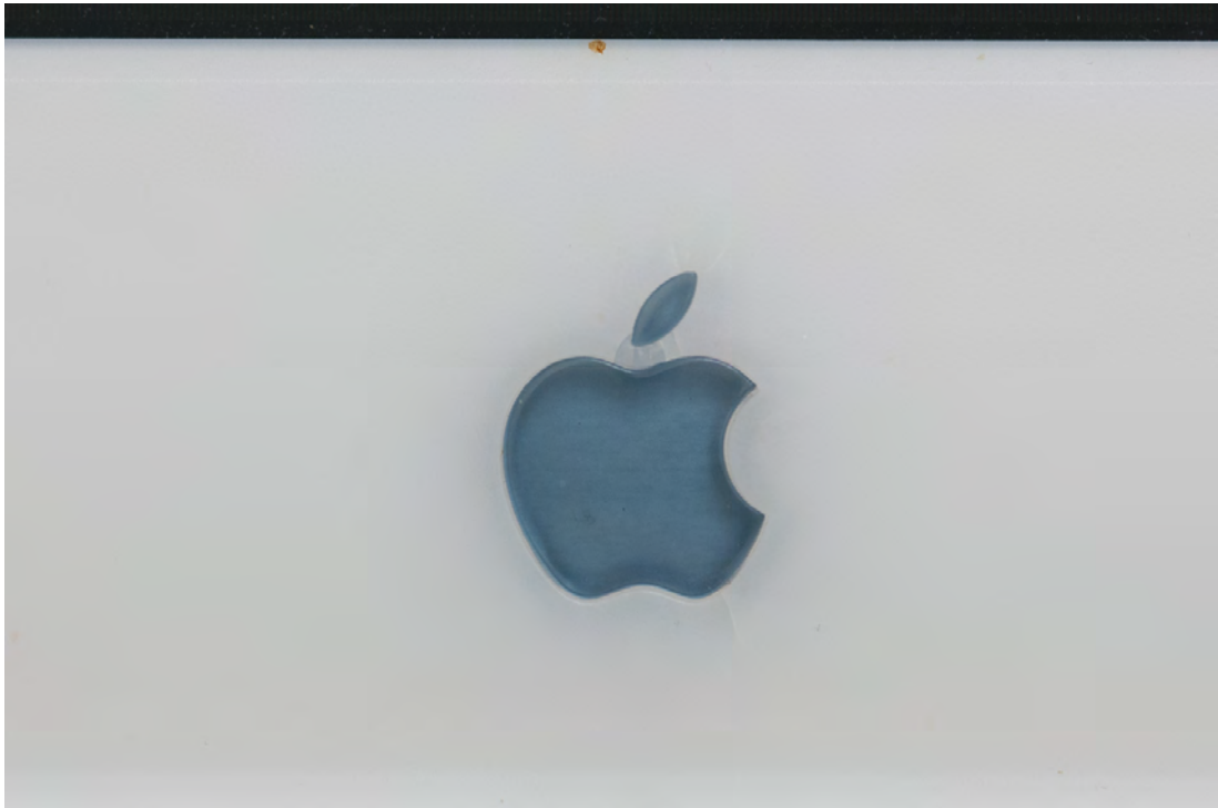
Abbildung A.26: Spannungsrisse am Logo unterhalb des Displays.
