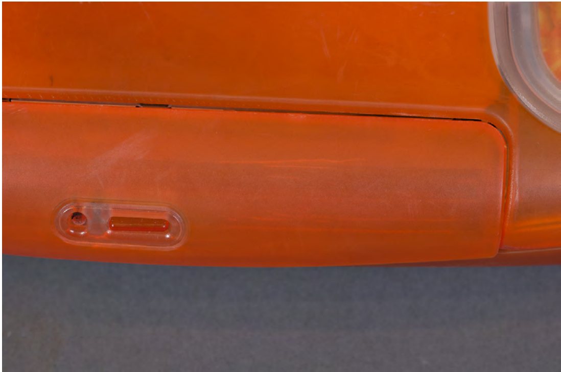
Abbildung A.12: Risse am CD-Laufwerk.
