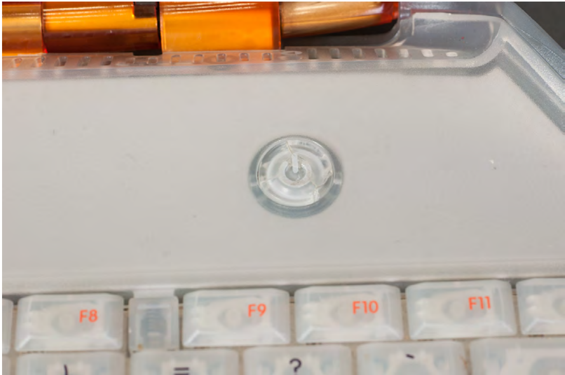
Abbildung A.10: Risse am Power-Knopf.
