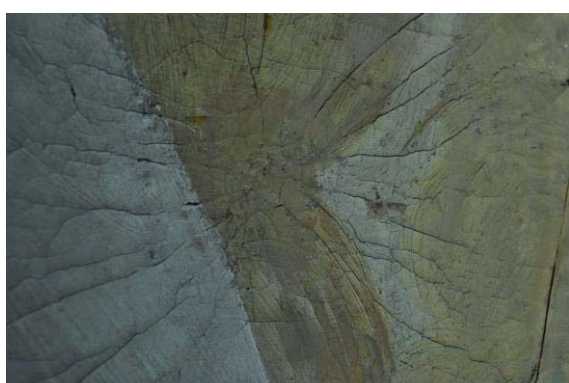
Abb. 174: Kittung oberhalb eines Nagels bzw. Nagellochs, von dem ein sternförmiges Craquelé ausgeht.
