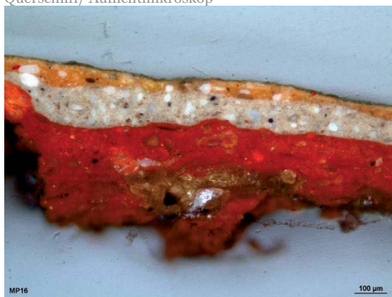
Streupräparat Grundierung / PLM Øpol
