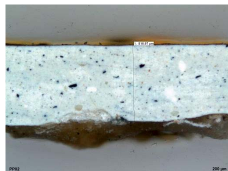
Abb. 94: Querschliff des Ausbesserungskitt, Probe PPO2: hier ca. 2mm dick.
