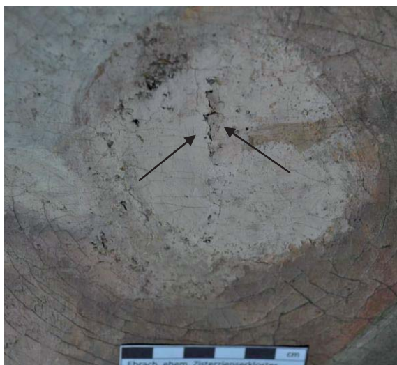
Abb. 129: Riss (Pfeile) in der Malschicht und der darauf liegenden Kittung innerhalb eines Spiralsprungs.
