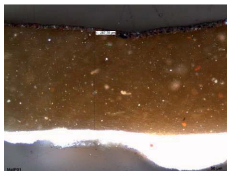
Abb. 95: Die Schichtdicke der Klebmasse beträgt bei der Probe MatPO1 ca. 2,5 mm.
