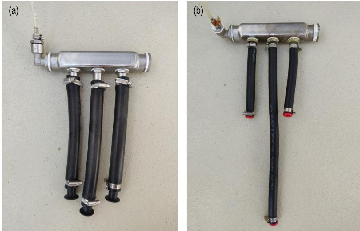
Abbildung 5.9. (a) Standardversion des CO<sub>2</sub>-Eintragssystems im Flachgerinnereaktor mit 3 Solvcarb-Schläuchen mit einer Länge von je 23 cm und einem Außendurchmesser von 27 mm. (b) Überarbeitetes CO<sub>2</sub>-Eintragssystem mit 2 äußeren Solvox B-Schläuchen (20 mm Außendurchmesser) von je 15 cm Länge und einem mittleren Solvox B-Schlauch mit 42 cm Länge, der in das Ansaugrohr der Kreiselpumpe eingetaucht wurde.
