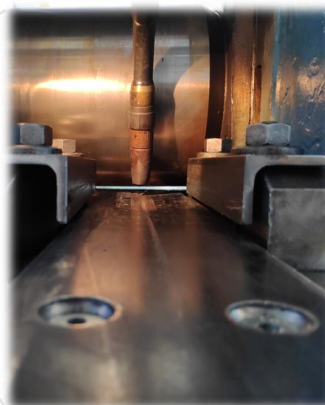
Justierbarer Schweißbrenner (Höhe, Winkelverstellung)
