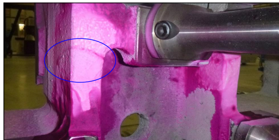
Abbildung 1.1.: Schadensfälle an dem in dieser Arbeit untersuchten Niederhalter durch initiierte Risse, mit freundlicher Genehmigung der BMW Group.
